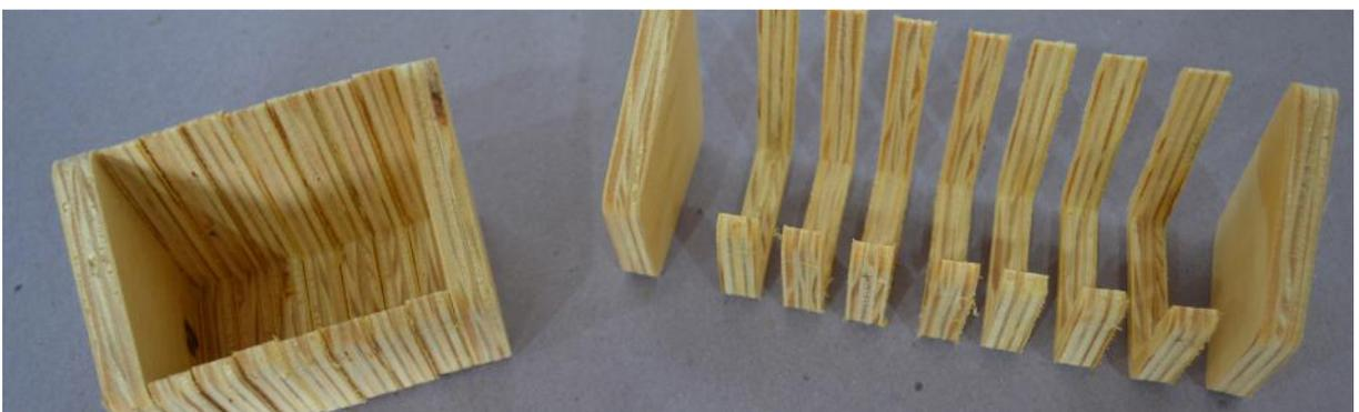
Figura IV.21 Imagens das peças direto do corte. De cima para baixo: módulo O, módulo L e caixa. Tamanho real.
