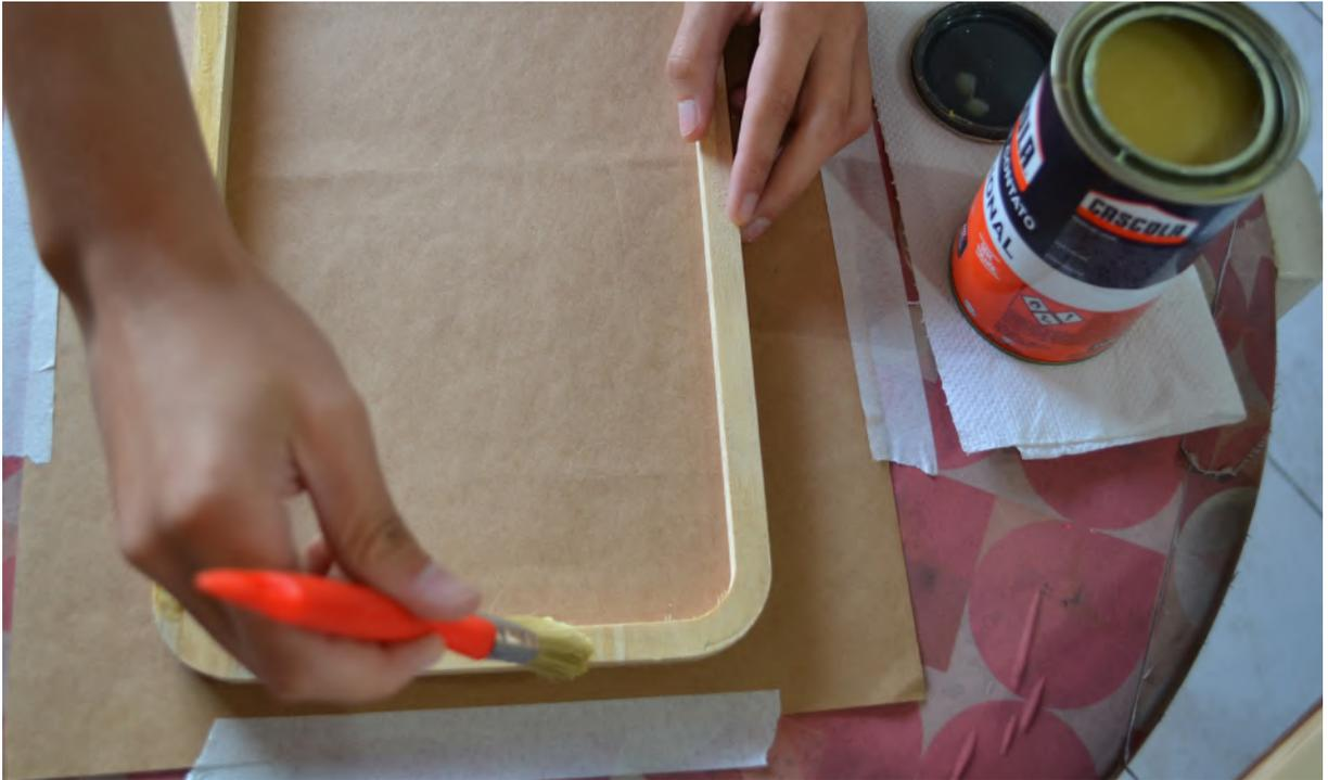
Figura IV. 24 Imagem da aplicação da cola de contato feita com pincel. Fonte: elaboração própria
