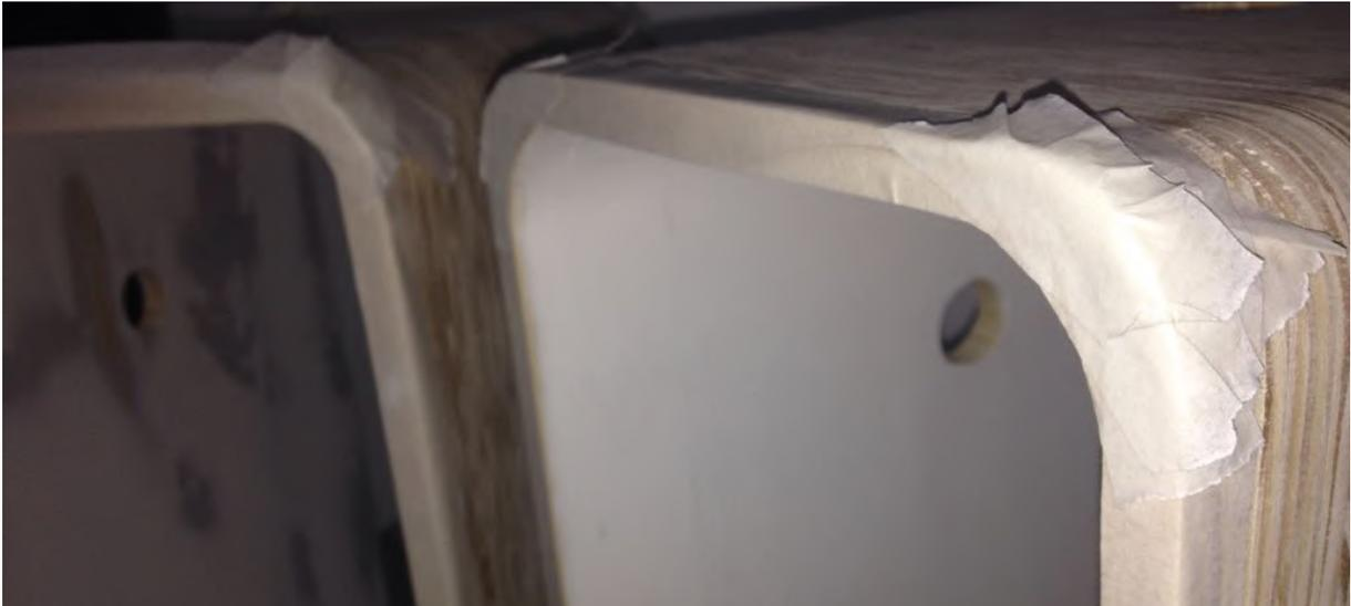
Figura IV.28 Imagem da aplicação da máscara com fita crepe. Fonte: elaboração própria
