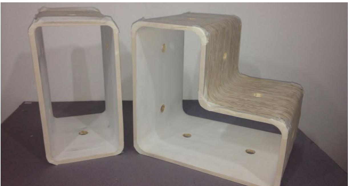
Figura IV.27 Imagem dos módulos depois da aplicação da massa de madeira. Fonte: elaboração própria
