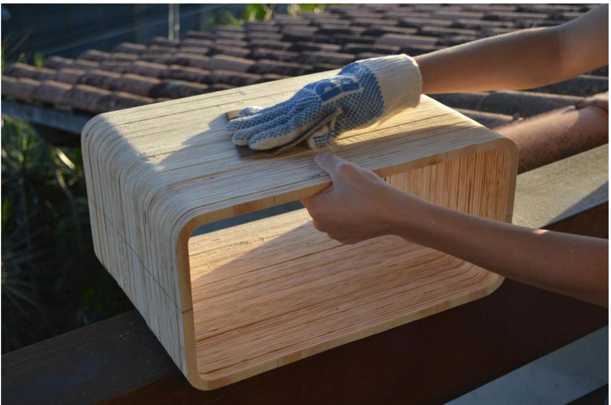
Figura IV.25 Imagem da remoção de rebarbas com lixa de madeira, gramatura 100 a 220. Fonte: elaboração própria
