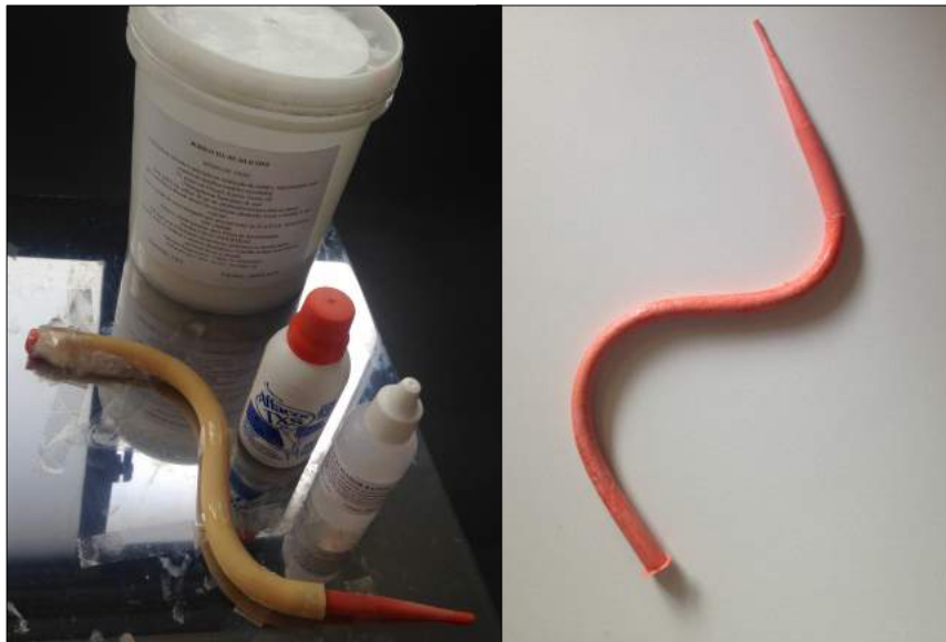
Figura 41. Componentes da moldagem do flagelo em silicone.
