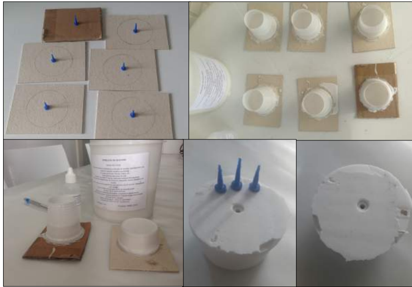
Figura 35. Componentes das etapas de moldagem em silicone a partir das fimbrias de PLA.
