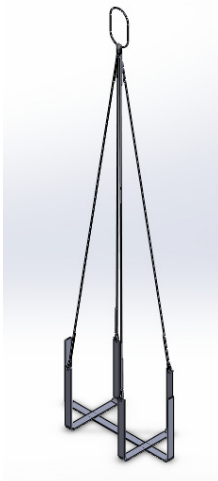
Figura 18 - Suporte do tanque de serviço do MDO.
