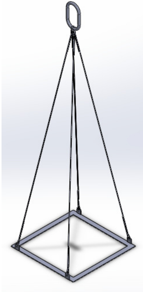
Figura 17 - Suporte do tanque de serviço do HFO.
