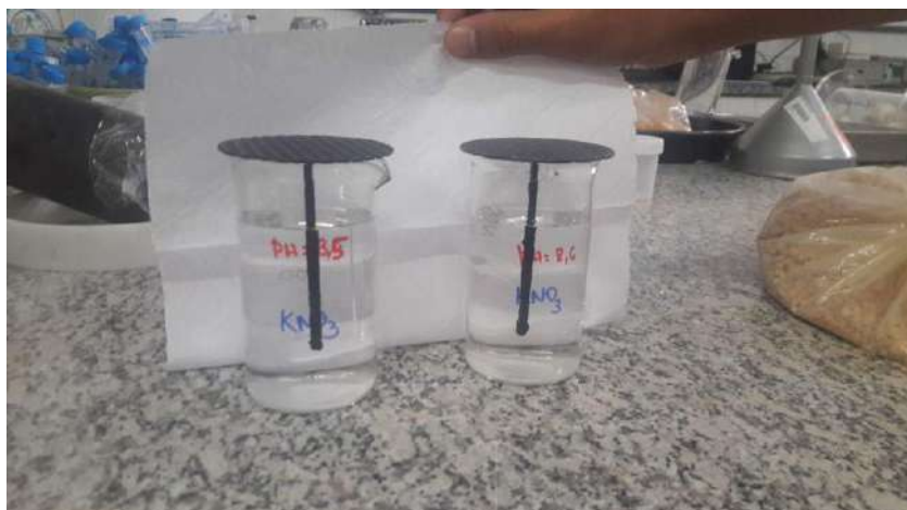
Figura 4.11 - Teste do Eletrodo por imersão em soluções com diferentes pH
