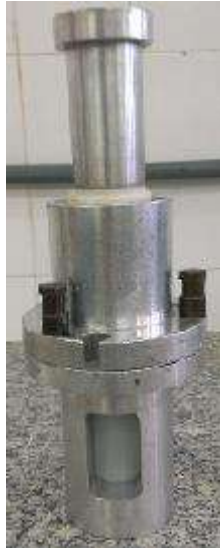
Figura 4.30 - Pistão utilizado para extração do líquido intersticial do solo
