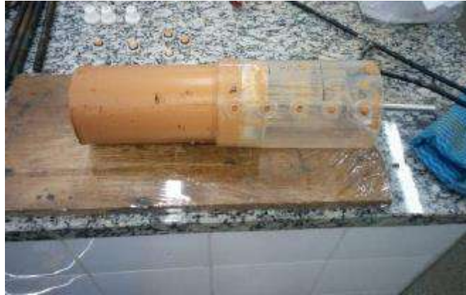
Figura 4.27 - Extrusão da amostra após ensaio eletrocinético
