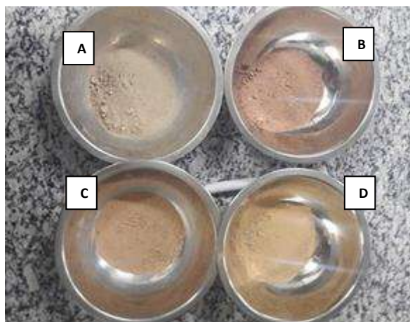
Figura 4.23 - Material após lavagem, secagem em estufa de 40°C e destorroamento
