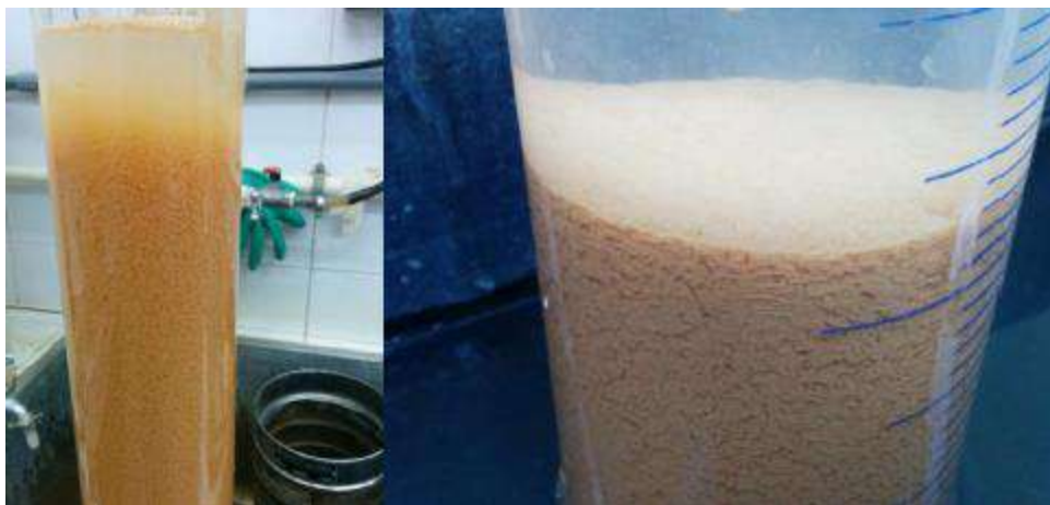
Figura 4.20 - Flocculação durante sedimentação sem defloculante
