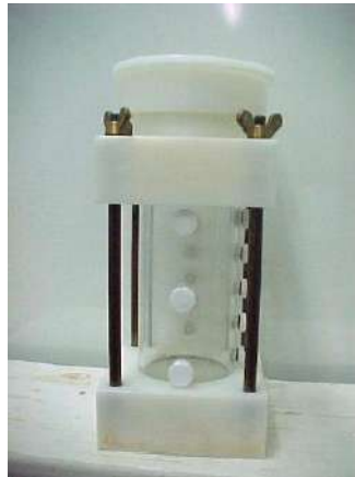
Figura 4.4 - Célula de moldagem – colarinho, topo, tubo da amostra, base e tirantes de metal.
