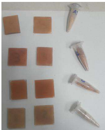
Figura 4.26 - Lâminas orientadas preparadas para análises de DRX
