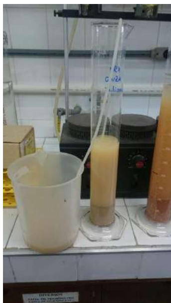
Figura 4.25 - Recolhimento do líquido por sifonação (Amostra A – Agregados Cinza)
