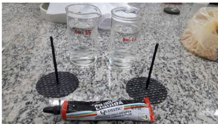
Figura 4.10 - Isolante utilizado nos eletrodos
