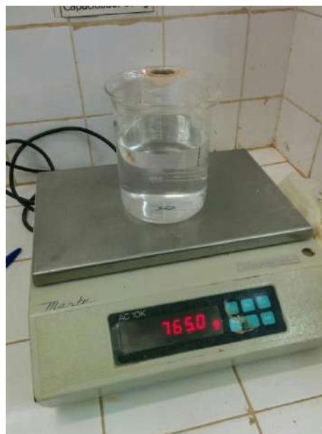
Figura 4.2 - Pesagem da água deionizada para moldagem do corpo de prova
