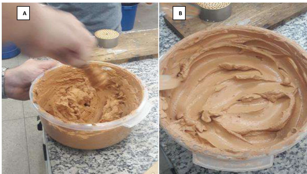
Figura 4.3 - Homogeneização da mistura com água inicial
