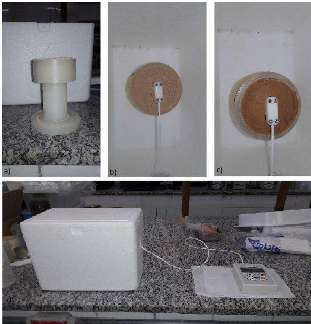
Figura 4.17 - Medição das propriedades térmicas: aparato cilíndrico para corpo de prova (a), corpo de prova solo seco (b), corpo de prova solo adensado (c), conjunto de medição.
