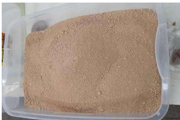
Figura 3 - Amostra após separação da fração mais grossa na peneira ASTM #10
