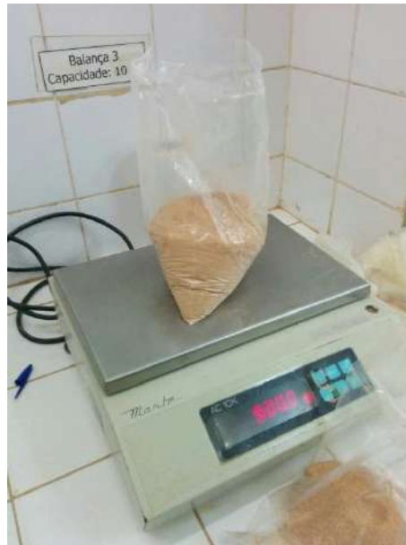
Figura 4.1 - Pesagem do solo seco para moldagem do corpo de prova
