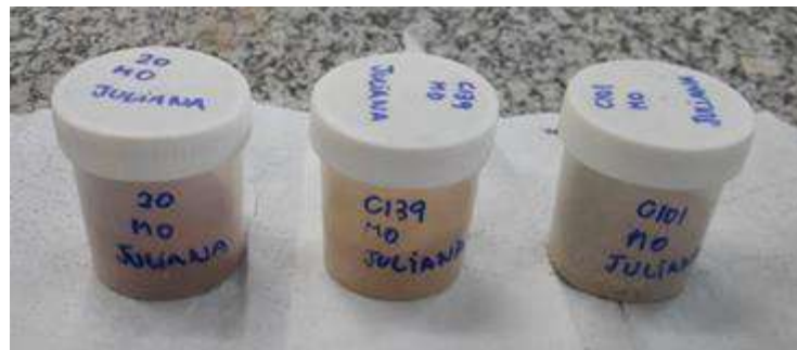
Figura 6 - Amostra para TMO após passagem na peneira # ASTM 80
