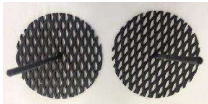
Figura 4.8 - Eletrodos de DSA® do Laboratório de Geotecnia, COPPE-UFRJ
