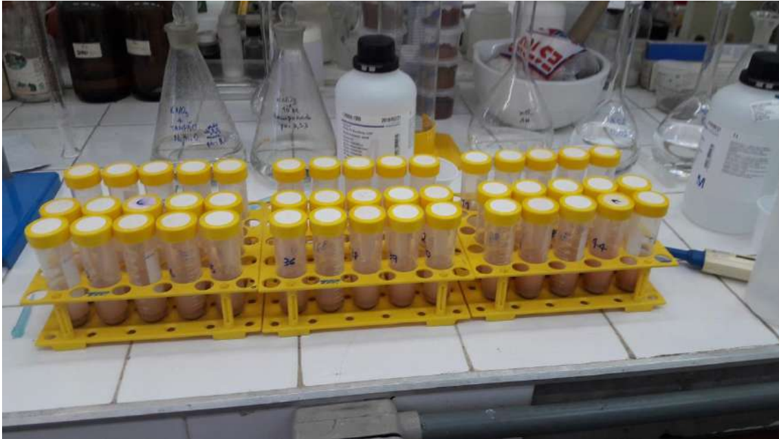
Figura 4.21 – Adição das soluções diferentes concentrações para determinação do PCZ
