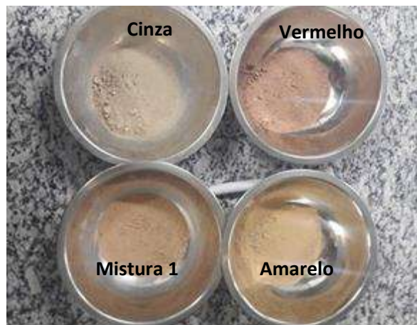
Figura 7 - Material DRX após lavagem, secagem em estufa de 40°C e destorroamento.
