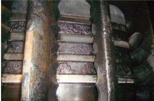
**Figura 3-12: Incrustações por conta do excesso de óleo lubrificante**
