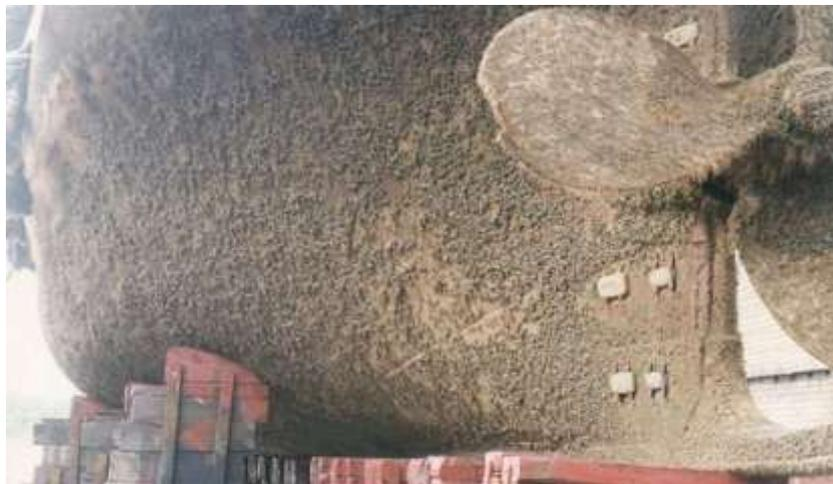
**Figura 3-17: Casco e propulsor com incrustações**
