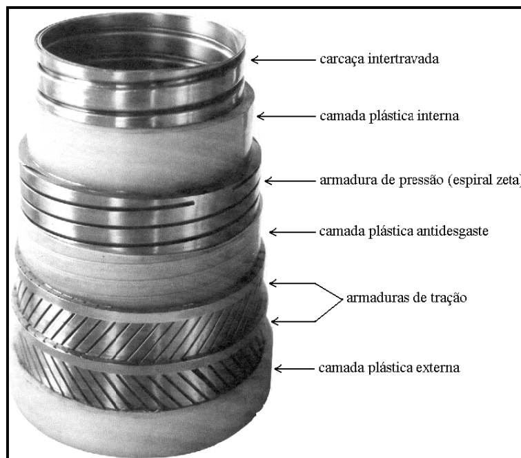
Figura II.24 – Riser Flexível – especificação das diversas camadas (típica linha flexível de camadas não-aderentes). (Sousa [6])
