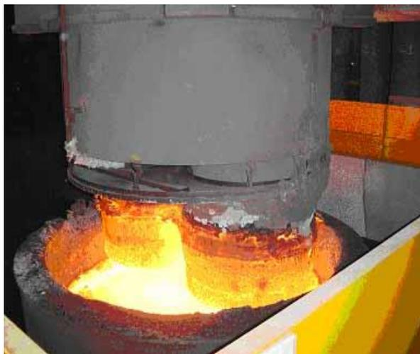
Figura 3 – Ilustração de um degaseificador a vácuo RH, com lança de oxigênio no topo. Reproduzida de Siemens VAI.
