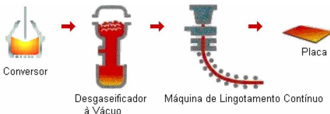
Figura 1 – Esquema básico de fabricação de aço IF. Reproduzida de [25].
