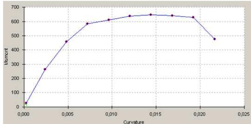
Figura 9.1.1 – Diagrama Momento x Curvatura do caso a
