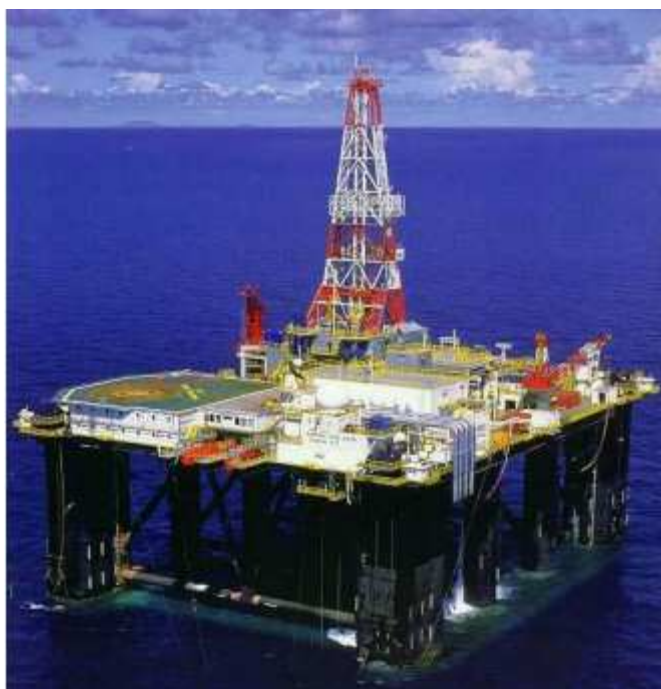
FIGURA 2.4: Plataforma tipo semi-submersível [1]
