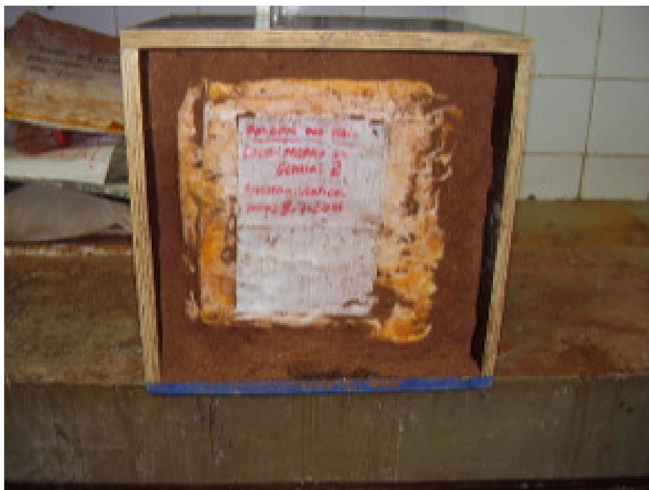
Figura 4.1 – Amostra (bloco cúbico de 30 cm de aresta por 30 cm de altura ) retirada da encosta do Morro da Glória II (AM-4) (COPPETEC, 2011)
