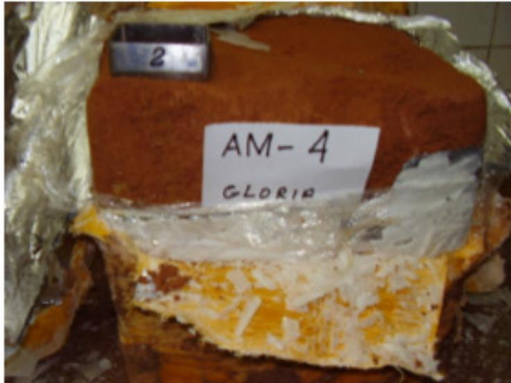
Figura 4.5 – Moldagem dos corpos de prova para o ensaio de cisalhamento direto (COPPETEC, 2011)
