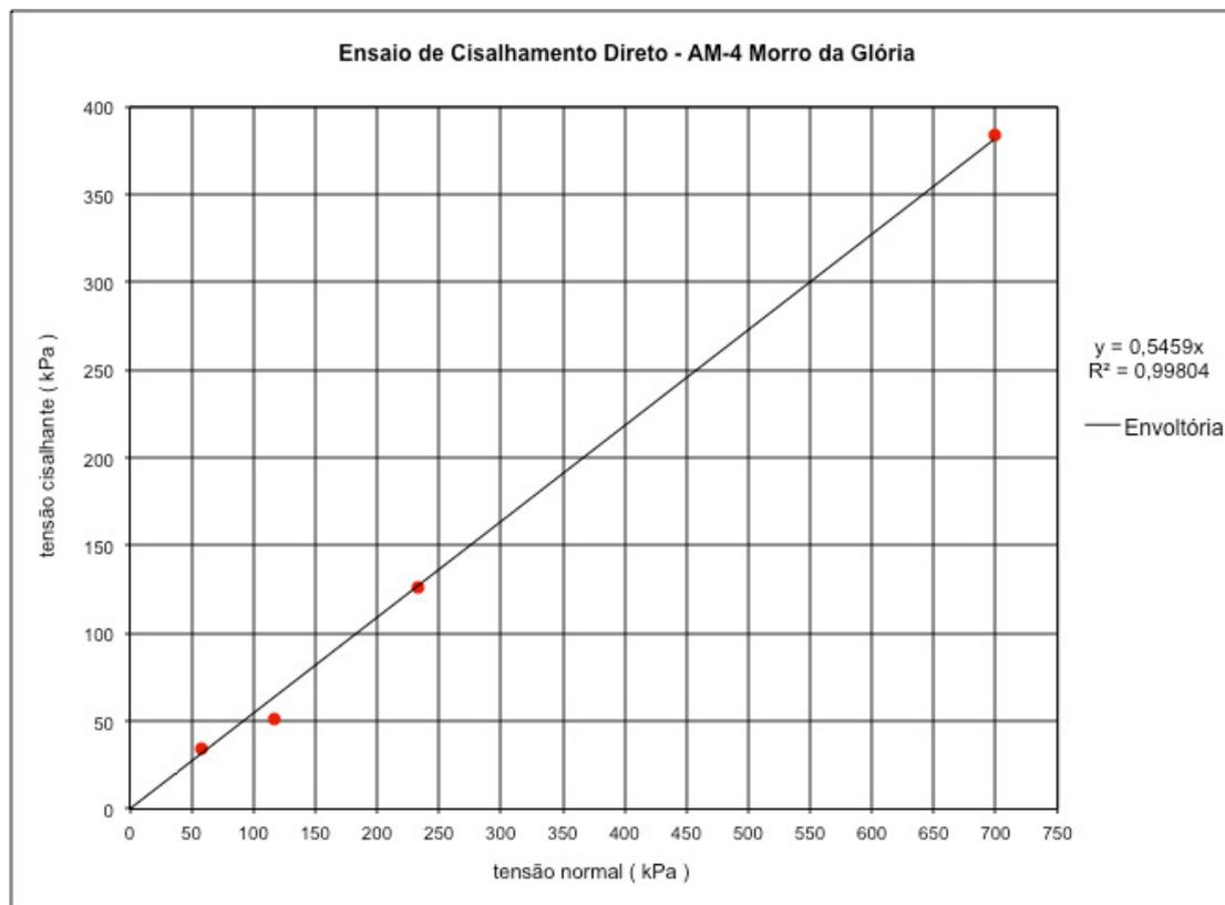
Figura 4.11 - Envoltória de resistência do ensaio de cisalhamento direto
