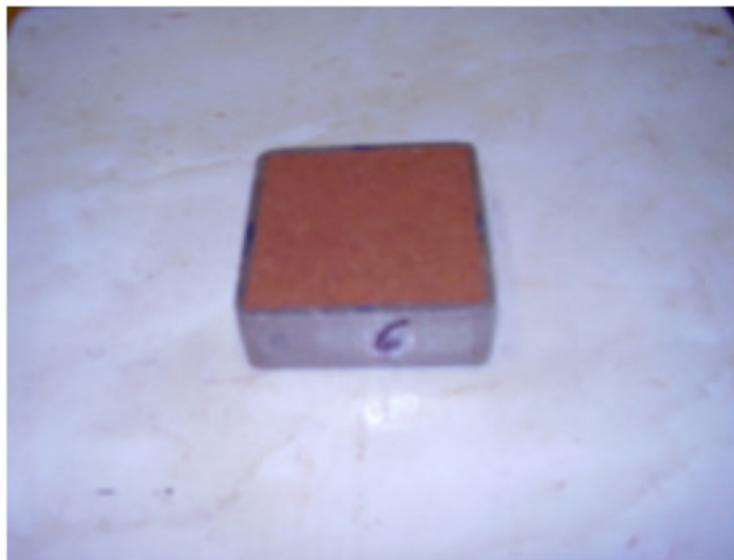
Figura 4.6 – Corpo de prova moldado para o ensaio de cisalhamento direto (COPPETEC, 2011)
