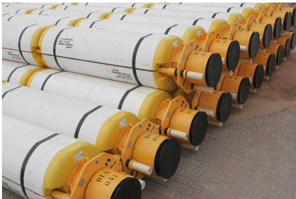
Figura 50 - Juntas de riser, é possível notar as demais linhas além da tubulação principal.
