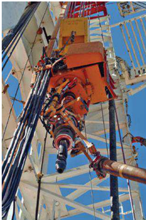
Figura 19 – Elevador levantando uma seção de revestimento e desenho esquemático do elevador Fontes: http://www.worldoil.com/uploadedimages/Issues/Articles/Mar-2004/04-03_key-Pruner_fig1.jpg http://www.sapwellsglobal.com/img/CasingElevatorSideDoorType.png
