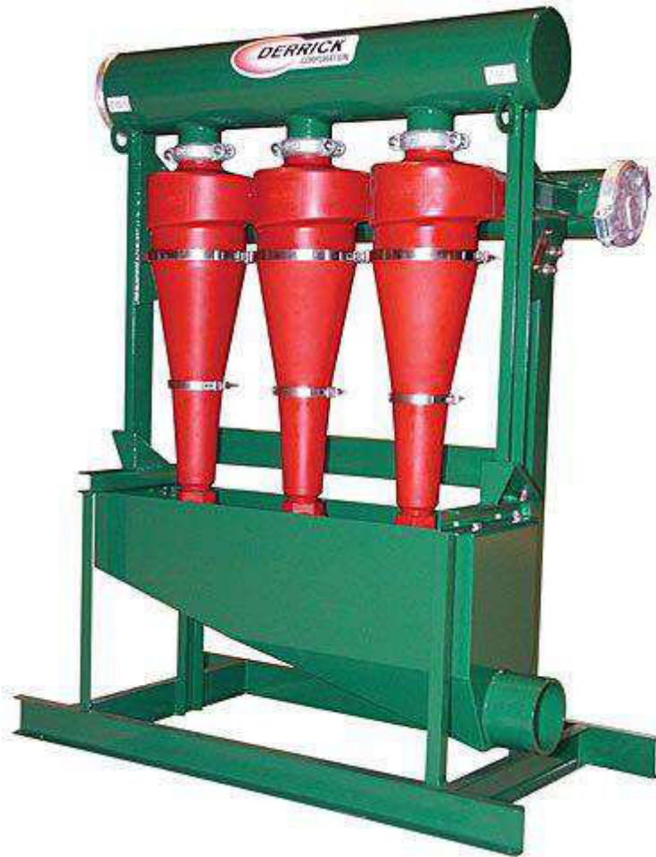
Figura 28 – Desareizador. Nota-se os hidrociclones em paralelo. ( http://www.prlog.org/12020490-hydrocyclone.jpg )
