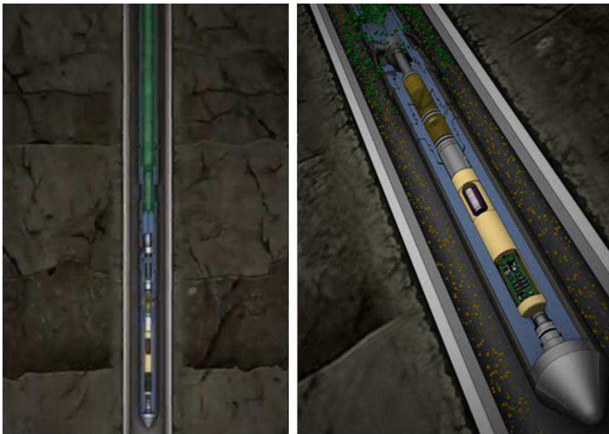
Figura 92 – Dump bailer inserido no poço. Em verde tem-se a representação do o cimento alojado no interior da ferramenta. Na figura da direita, com o mecanismo acionado, o cimento é liberado no poço.
