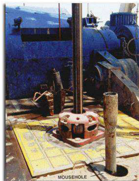
Figura 57 – Mouse hole com seção de drill pipe alojada em seu interior ( http://www.blueridgegroup.com/v4.0/index-1-2.html )
