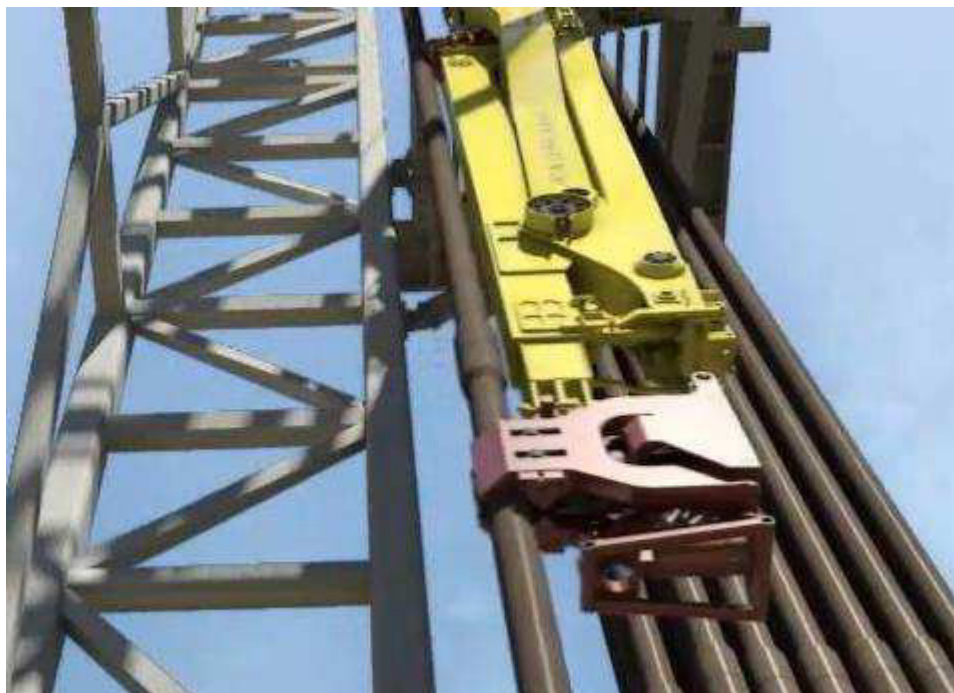
Figura 21 – Iron Derrickman pegando uma seção de drill pipe com objetivo de conectá-la ao top drive ( http://www.youtube.com/watch?v=fOBjkw0XGg )
