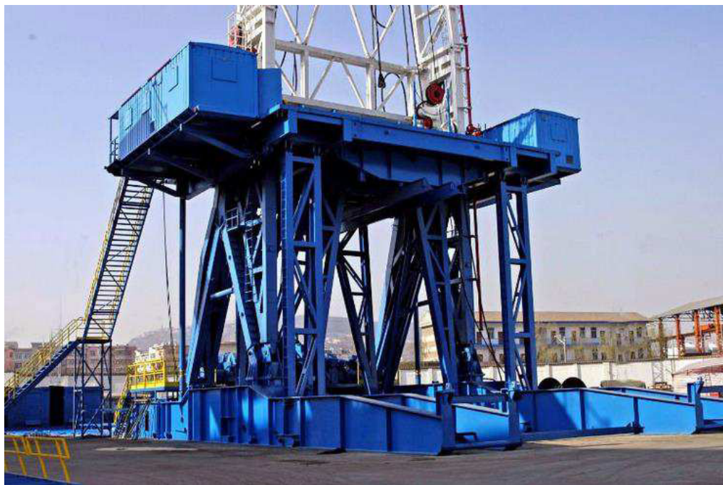
Figura 54 – Subestrutura da sonda, acima da qual é montada a torre de perfuração e uma série de outros equipamentos
