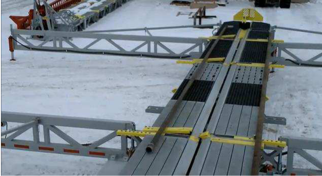
Figura 15 – Estaleiro de tubos (Pipe rack) automático ( https://www.youtube.com/watch?v=XWmSUwjWGZ4 )
