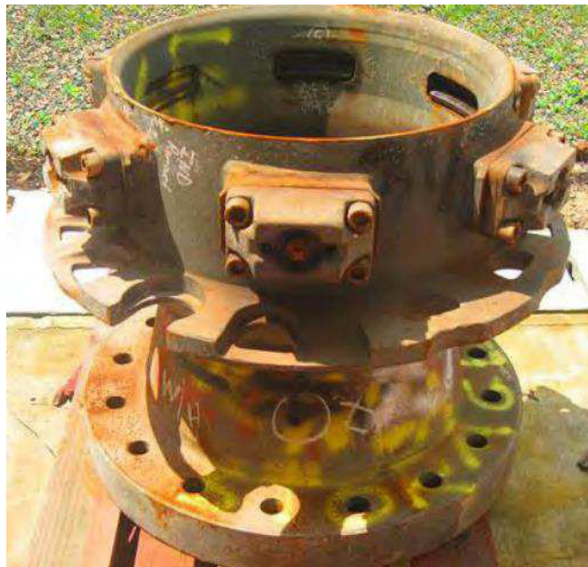
Figura 72 – Adaptador de riser, usado para fazer a conexão entre o LMRP e a coluna de riser. ( http://www.energyclaims.net/assets/Marine-Drilling-Riser-and-LMRP.pdf )
