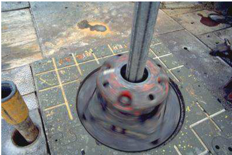
Figura 2 - Conjunto mesa rotativa, Kelly e Kelly Bushing, adjacente é possível ver o Mouse Hole
