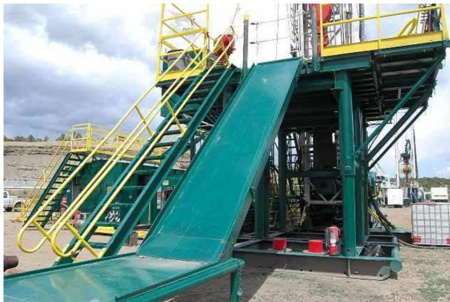
Figura 16 – Esteira de tubos (Pipe Catwalk) de uma sonda de terra, os tubos ficam inclinados na rampa, com parte de seu comprimento acima do piso da plataforma ( http://www.sunmachinery.com/images/5036N_15.jpg )
