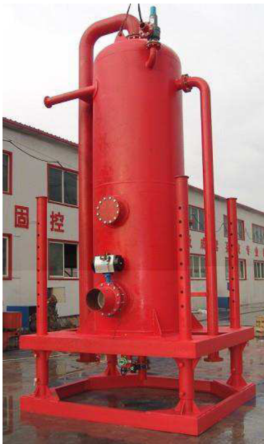
Figura 31 – Poor boy, degaseificador utilizado para situações de kick ( http://oilfield.gnsolidscontrol.com/wp-content/uploads/2009/08/Poor-boy-degasser.JPG )
