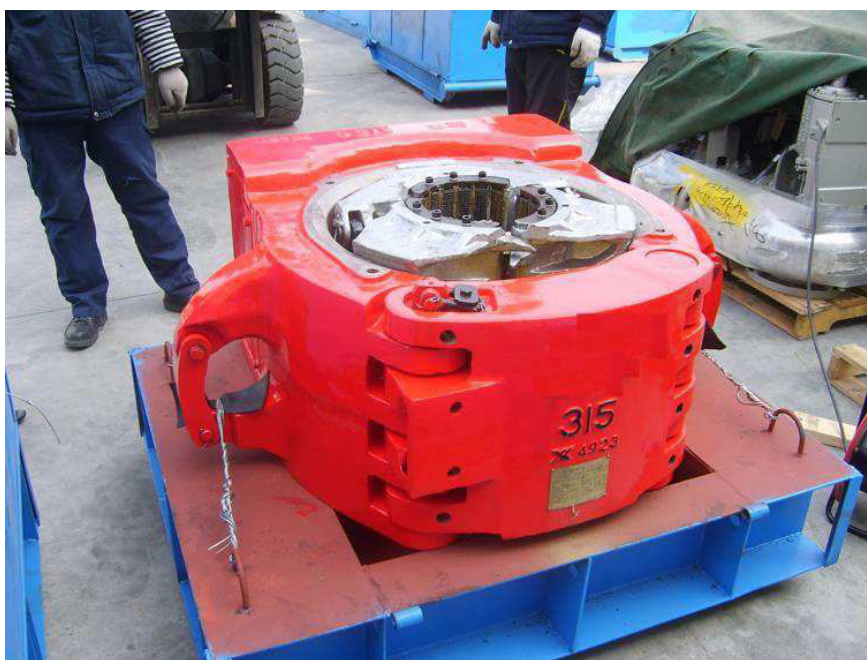
Figura 60 – Aranha ou spider usado para sustentar o revestimento enquanto se faz uma nova conexão. Neste caso o equipamento em questão foi dimensionado para trabalhar sobre cargas de até 315 toneladas.
