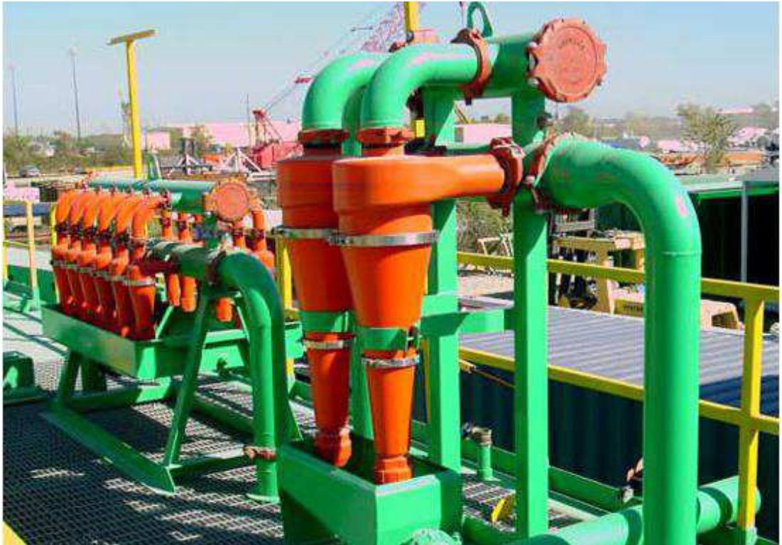
Figura 29 – Em primeiro plano, pode-se ver o desareiaador. Em segundo plano, com uma quantidade maior de pequenos hidrocilcones pode-se ver o dessiltador.
