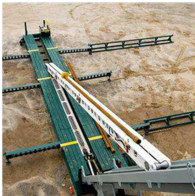
Figura 17 – Esteira de tubos automática
