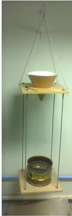
Figura 3.2: Pluviação para obtenção de corpo de prova
