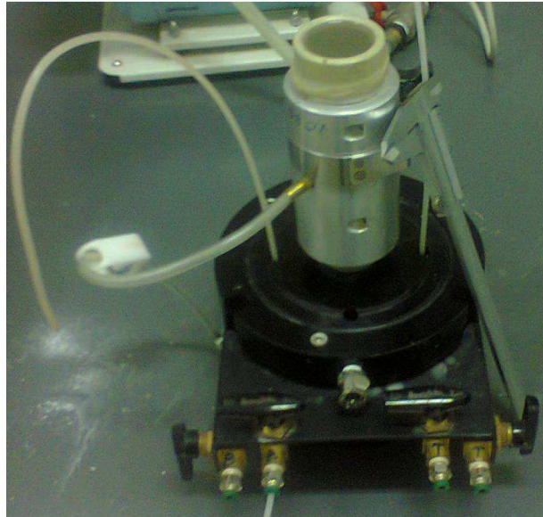
Figura 3.31: Detalhe da moldagem de corpo de prova arenoso
