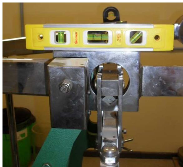
Figura 3.20: Nível de bolha para verificação da horizontalidade
