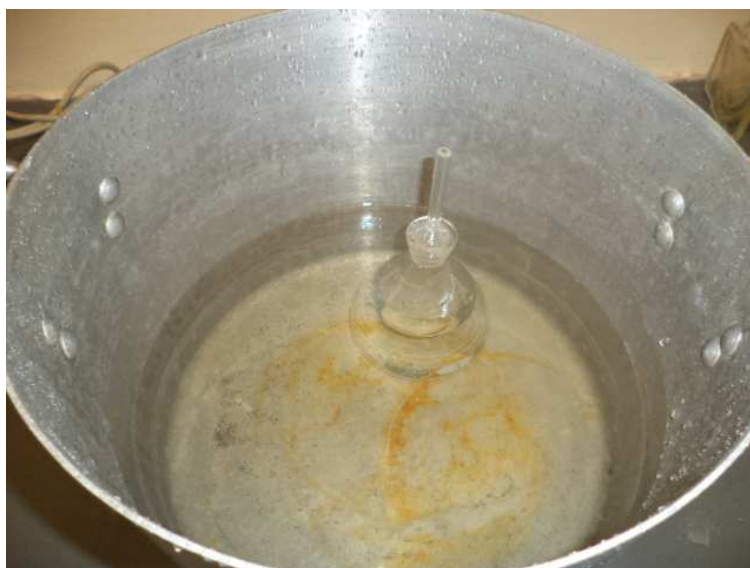
Figura 3.25: Banho-maria para redução da temperatura da água desaerada
