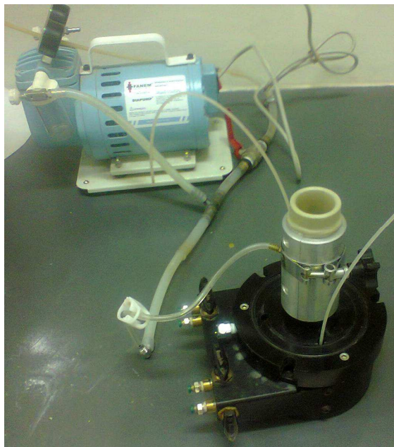
Figura 3.30: Adesão da membrana ao molde com auxílio de bomba de vácuo
