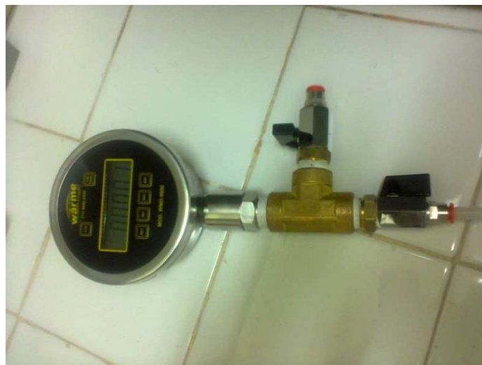
Figura 3.22: Manômetro digital utilizado para calibração do FlowTrac-II
