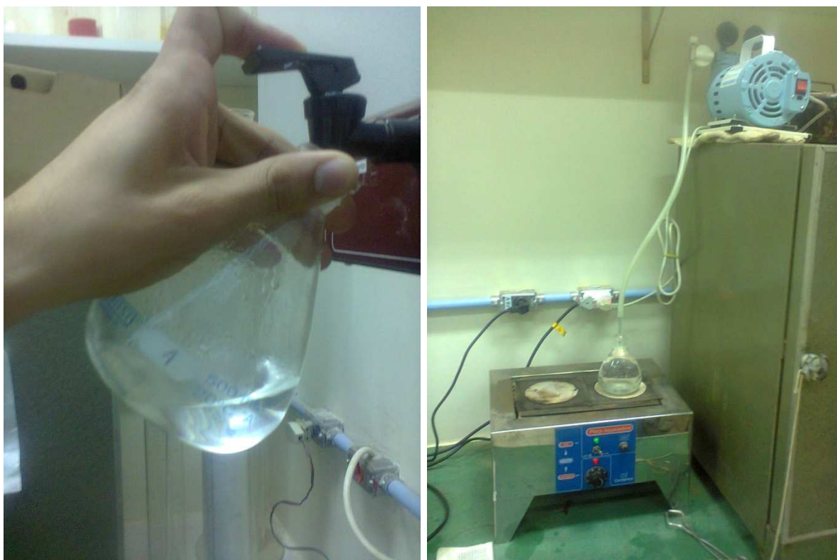
Figura 3.24: Coleta cuidadosa de água destilada (esquerda) e aplicação de vácuo e aquecimento (direita)
