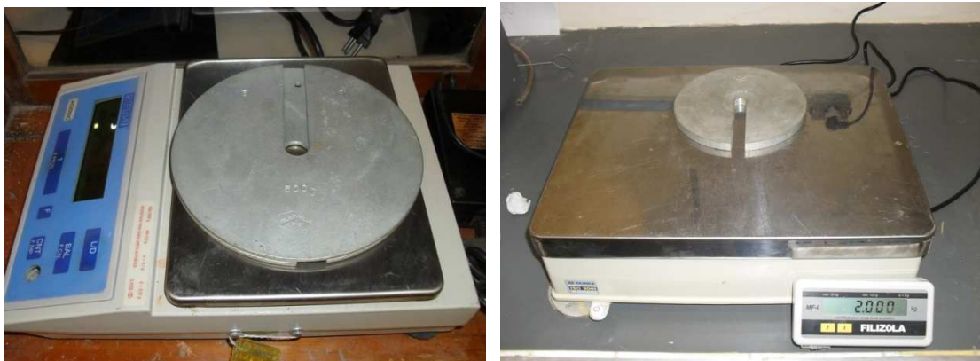
Figura 3.19: Balança com resolução de 0,01g (esquerda) e com resolução de 5g (direita)
