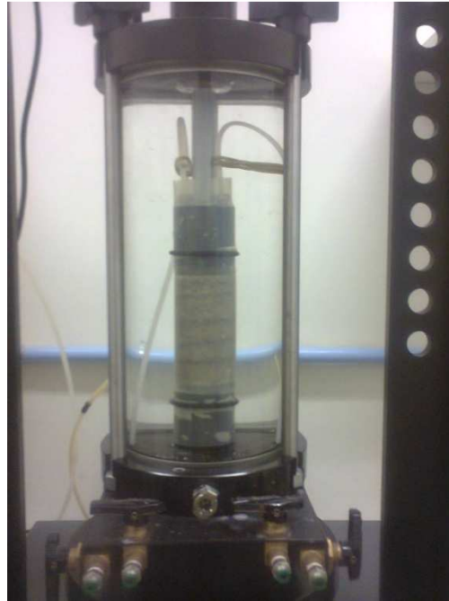
Figura 3.32: Célula triaxial com corpo de prova envolvido por água
