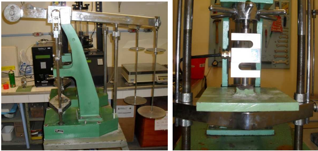
Figura 3.18: Prensa de adensamento (esquerda) usada para calibração e placa com porca utilizada para posicionamento da célula de carga
