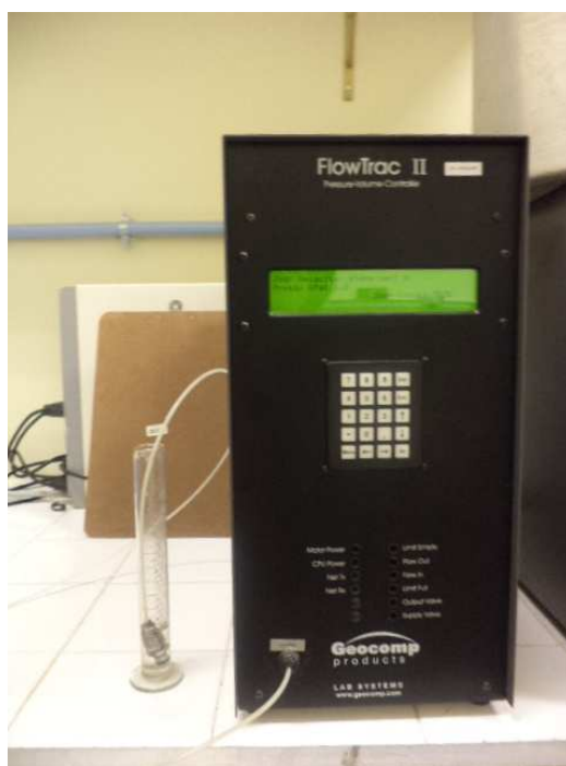
Figura 3.21: Proveta utilizada para ratificação do medidor de volume
