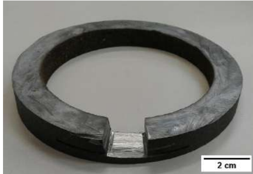
Figura 4-2 – Anel de onde serão retiradas as amostras para caracterização.
