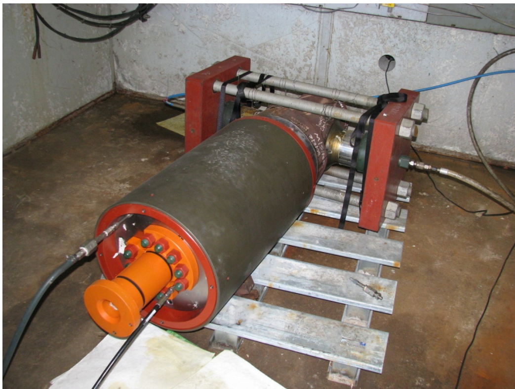
Figura 16: Válvula e atuador durante teste de fábrica [3]
