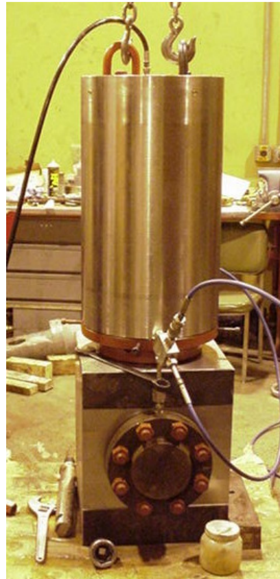
Figura 15: Válvula e atuador durante qualificação [3]
