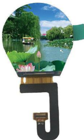
Figura 67: Tela TFT LCD redonda com ângulo de visão IPS (fonte: www.ebay.com ).
