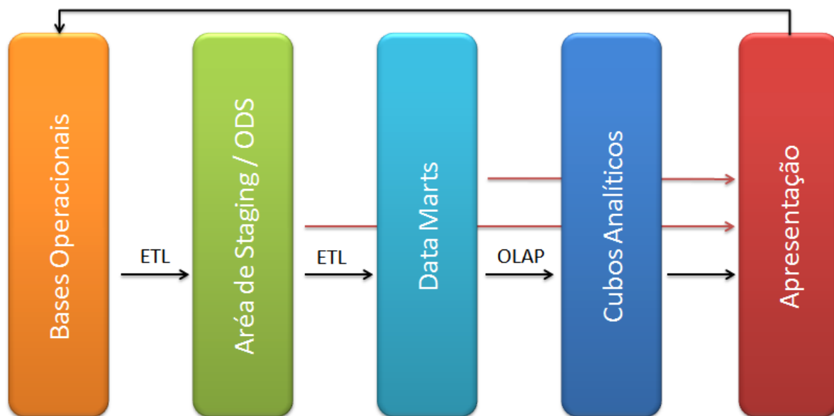
Figura 1 - Componentes de um data warehouse
