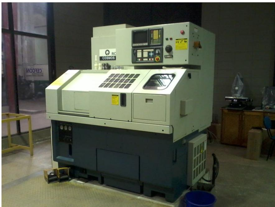
**Figura 17:** Torno CNC Romi Cosmos 10U utilizado na usinagem.
