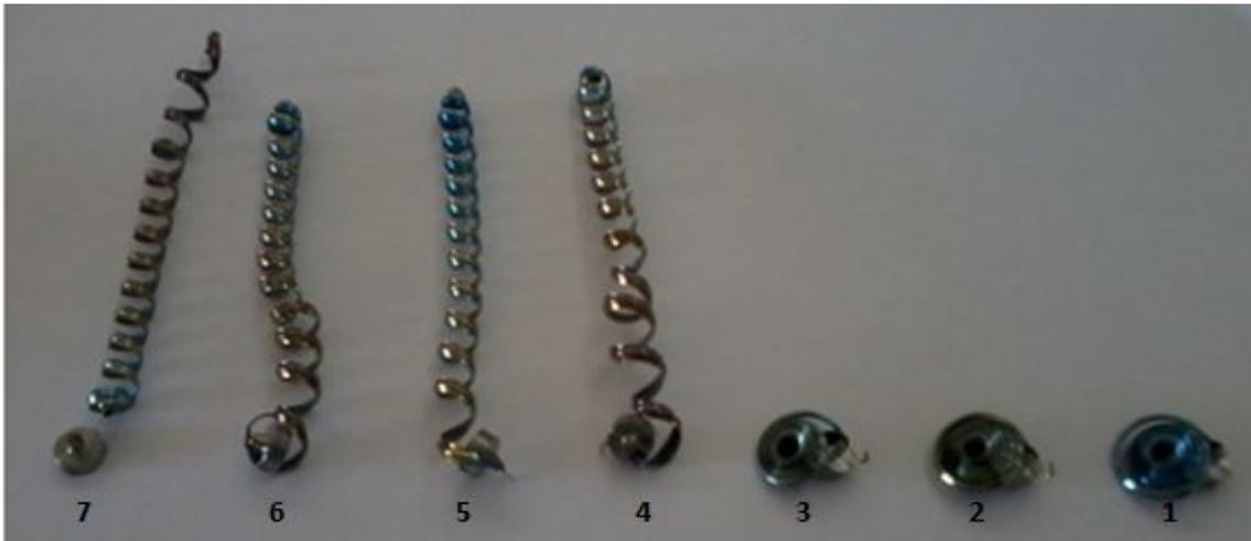
**Figura 26:** Amostras usinadas. Nota-se a mudança no formato do cavaco com o número do teste.
