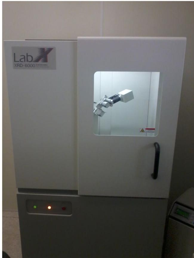
**Figura 35:** Difratorômetro de Raio X shimadzu.
