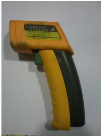
**Figura 39:** Pistola de infravermelho para medir as temperaturas alcançadas na usinagem.
