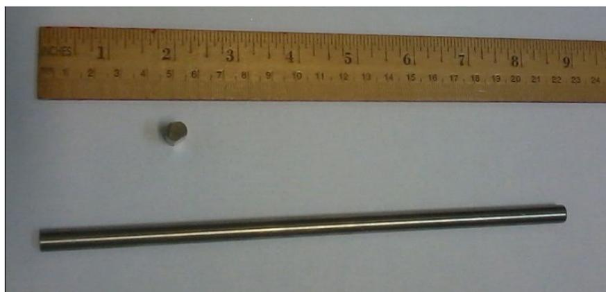
**Figura 15:** Barra cilíndrica de NiTi utilizada para as análises.
