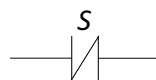
Figura 3.24: Contato NF associado à variável S . Quando o valor lógico de S for igual a 1, o contato NF abre, interrompendo a continuidade lógica do trecho do diagrama em que está inserido.
