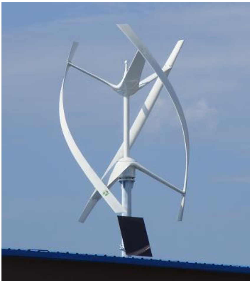
Figura 2.5: Turbina eólica de eixo vertical
