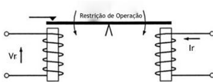
Figura 3.7: Princípio de funcionamento do relé de distância
