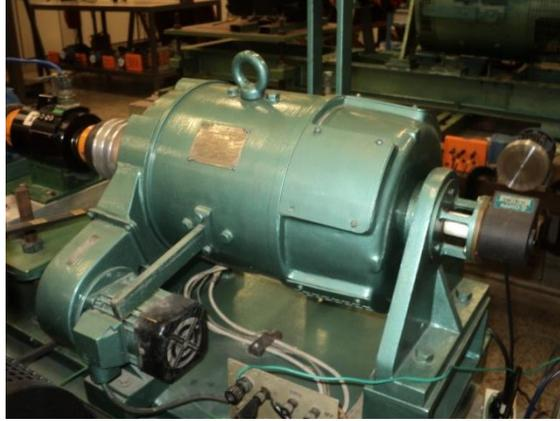
Figura 25: Gerador de corrente contínua
