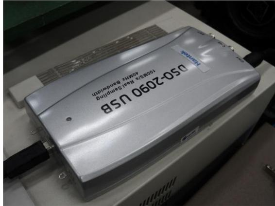
Figura 30: Osciloscópio digital USB DSO-2090
