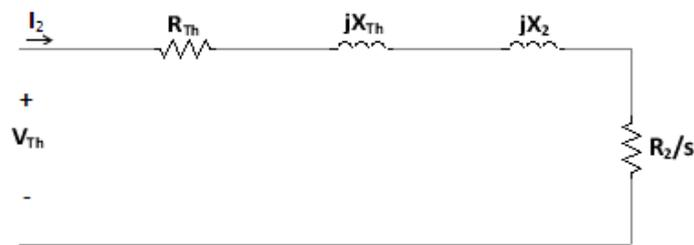
Figura 9: Modelo do motor de indução com equivalente de Thévenin
