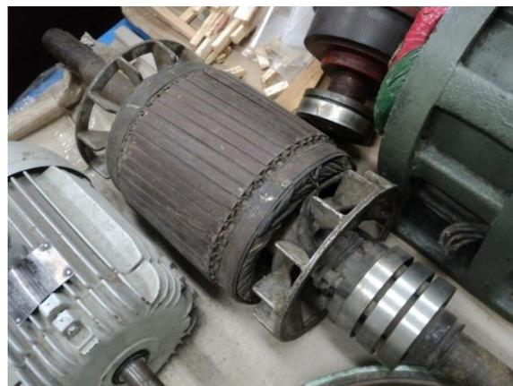
Figura 6: Rotor bobinado
