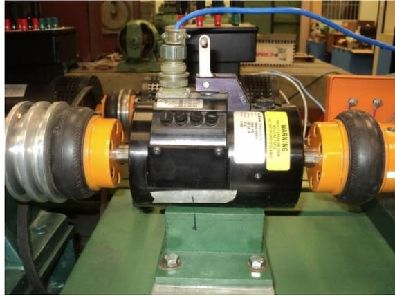
Figura 32: Sensor de torque
