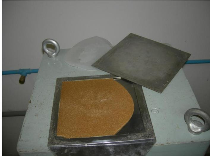
**Figura 4.8:** Disco de polipropileno com fibras de madeira, preparado após prensagem do material homogeneizado no misturador termocinético.
