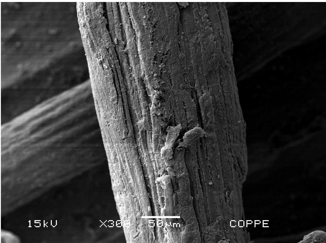
**Figura 5.7:** Detalhe de fibra tratada com oxigênio, 60 minutos, 80 W de potência
