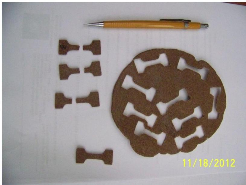
**Figura 4.10:** Corpos de prova obtidos à partir de disco de material compósito.
