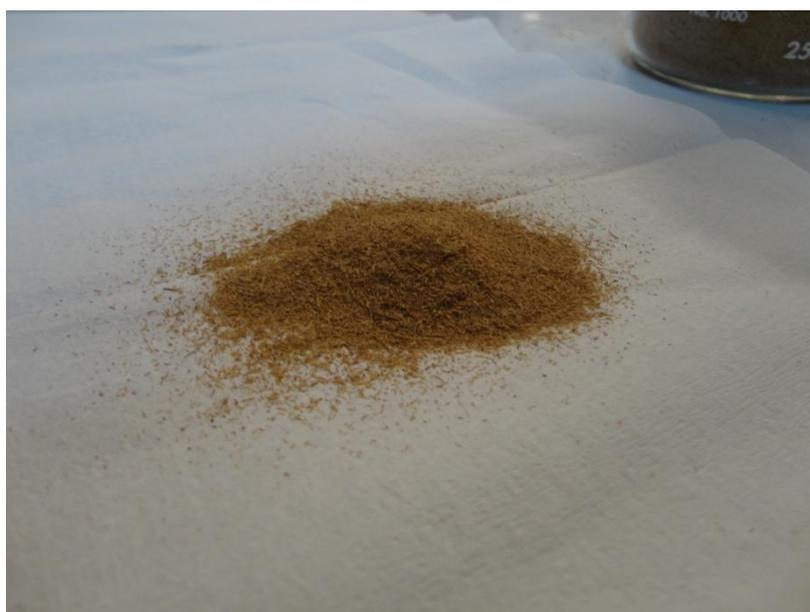
**Figura 4.2:** Aspecto das fibras de coco após etapas de preparação.
