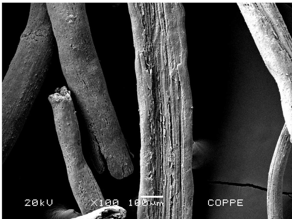
**Figura 5.9:** Fibras tratadas com ar atmosférico, 60 minutos, 50 W, em pouca quantidade.
