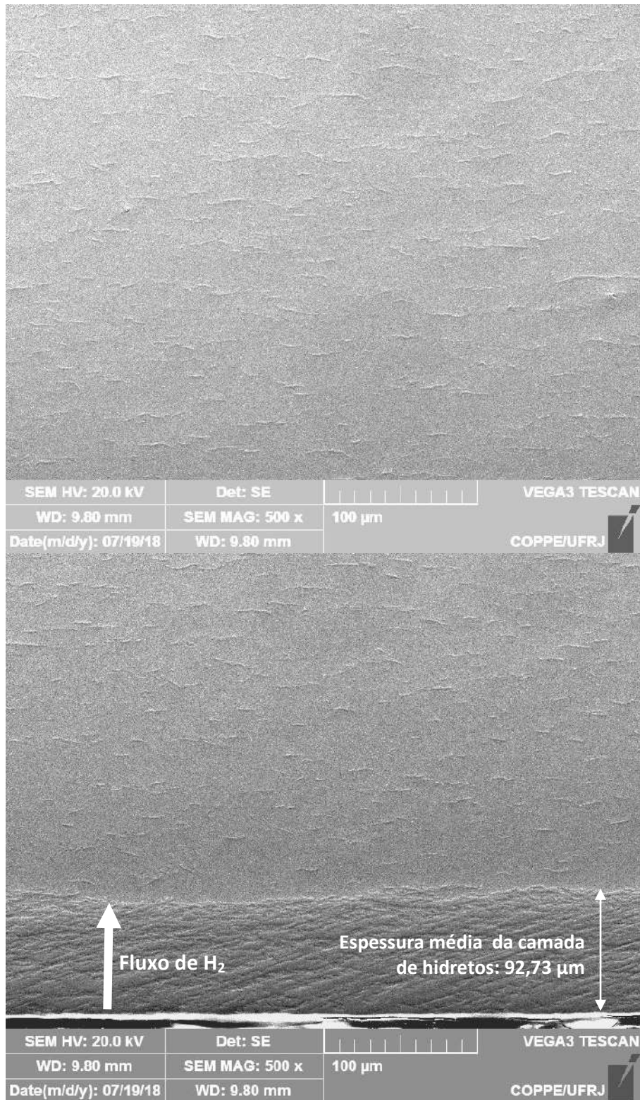
Figura 65: MEV do ensaio de permeação de H 2 realizado a 320°C, 2 bar, 15h da liga Zir-Brasil1 na amostra na condição TT2_580°C,4h_recrystalizada, em seção transversal, aumento de 500x (a) superior e (b) inferior.
