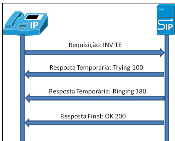
Figura 5.3: Esquemático representativo da transação entre cliente e servidor
