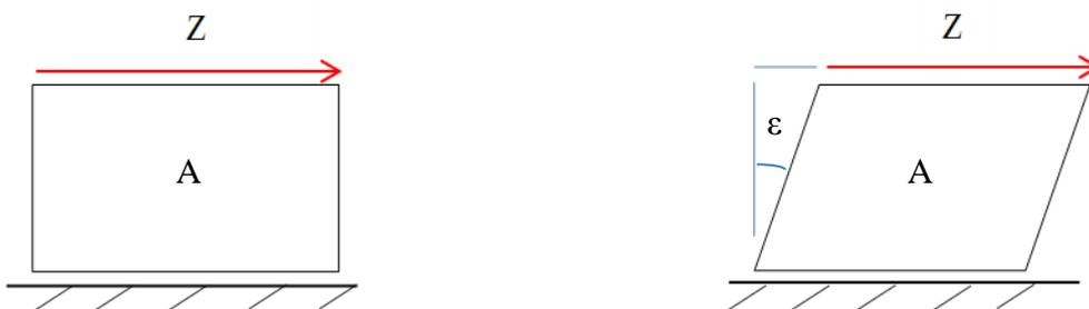
Figura 2: Ilustração mostrando a ação de uma força tangencial ( $Z$ ) à superfície, gerando uma tensão de cisalhamento.
