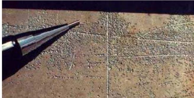
Figura 5 - Corrosão por Pit em aço inox
