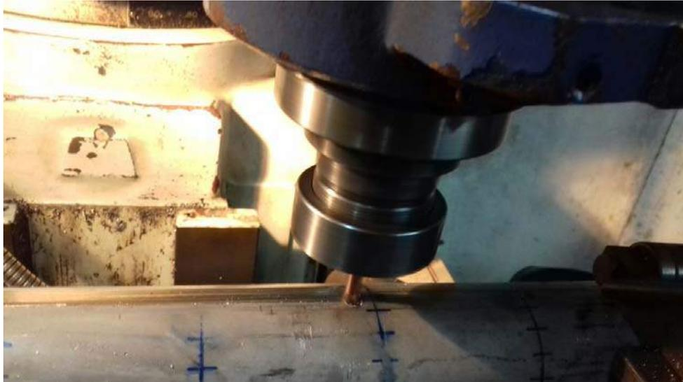
Figura 30 – Usinagem do tubo
