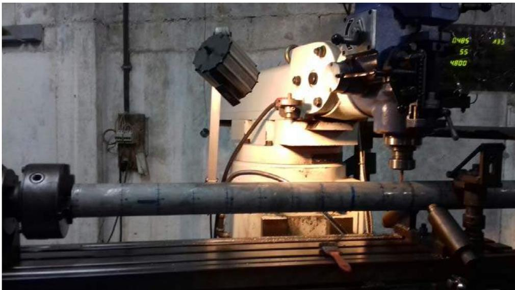
Figura 29 – Usinagem do tubo
