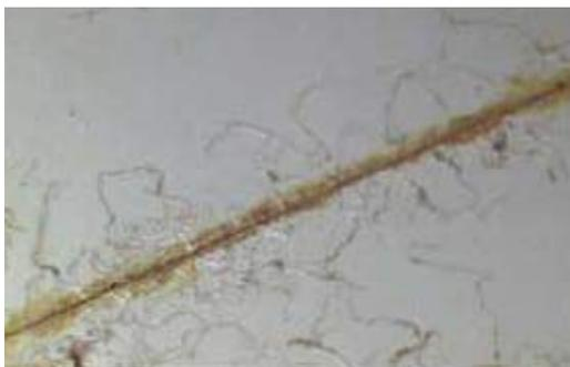
Figura 7 - Corrosão filiforme: filamentos em torno do risco na chapa de aço carbono pintada
