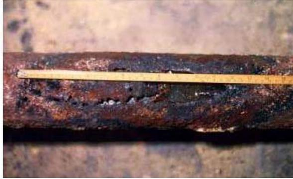
Figura 2 - Corrosão uniforme em tubo enterrado
