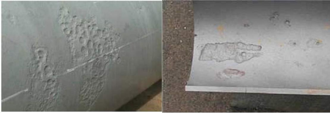
Figura 9 – Corrosão na superfície externa (esquerda) e interna (direita) do duto
