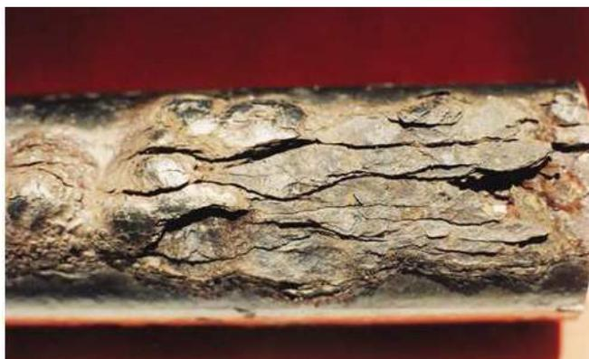
Figura 8 - Esfoliação em tubo de aço-carbono
