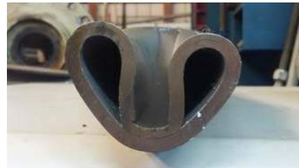
Figura 51 – Modelo de colapso U-1 no modelo numérico
