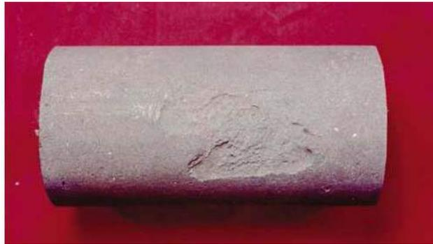
Figura 3 - Corrosão em placas em tubo aço-carbono
