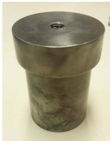
Figura 34 – Tampa de vedação para o teste de colapso
