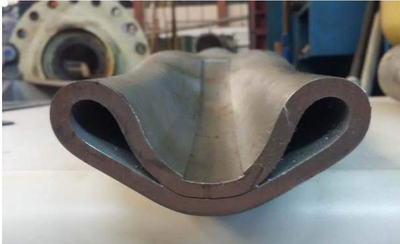
Figura 40 – Modo de Colapso tipo U3
