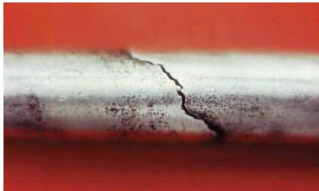
Figura 6 - Corrosão sob tensão fraturante em tubo de aço inox AISI 304
