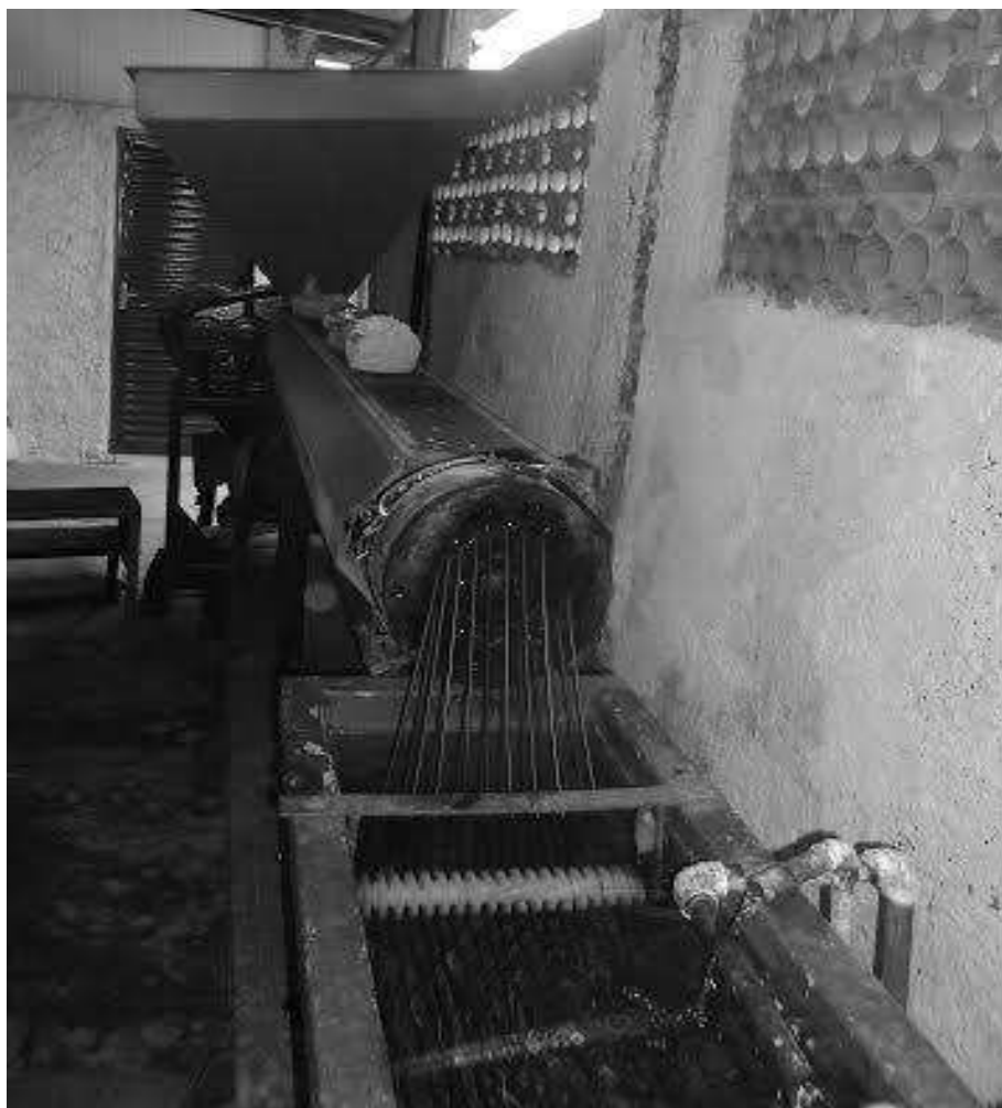
Figura 22. Processo de extrusão. Fonte: cedida pelo consultor do Jogue Limpo no Rio de Janeiro.
