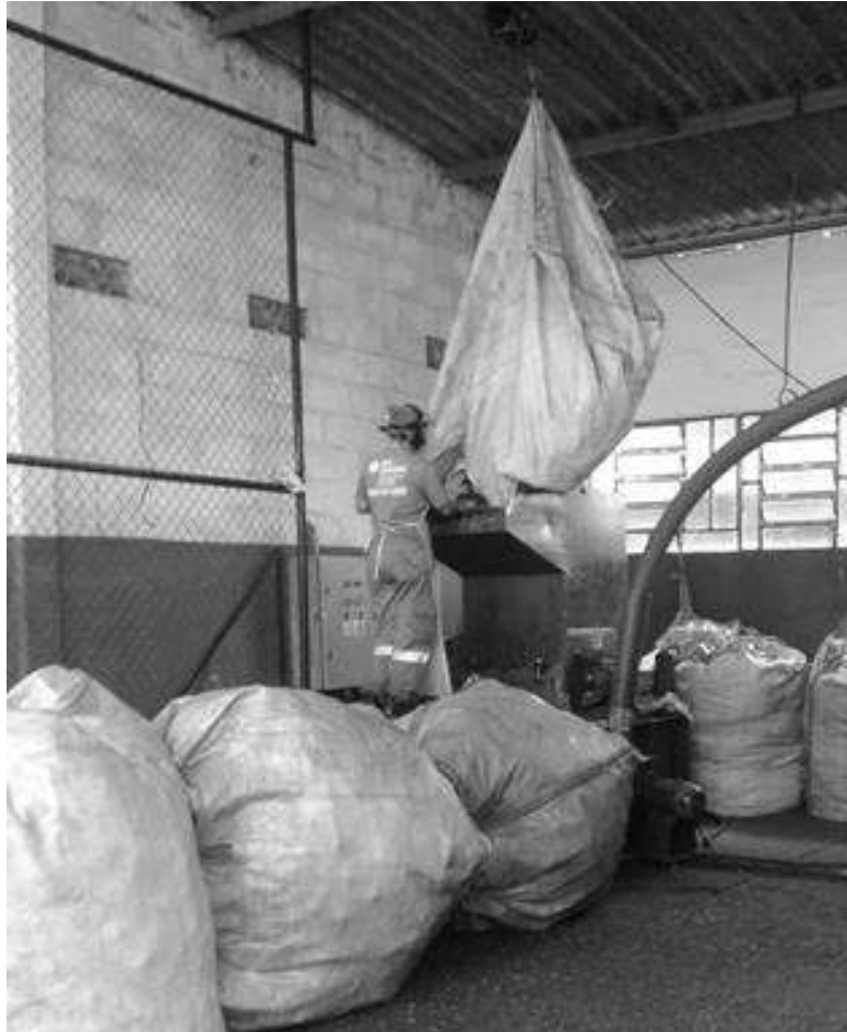
Figura 19. Etapa de trituração das embalagens. Fonte: fotografia própria.
