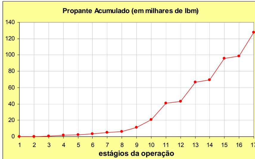
Figura 28. Propante acumulado em fratura *Tip Screenout*
