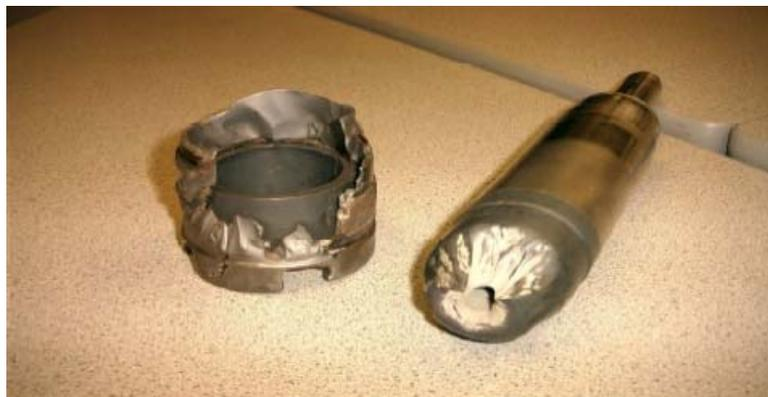
Figura 1. Efeitos de erosão de *choke* decorrentes da produção de areia.
