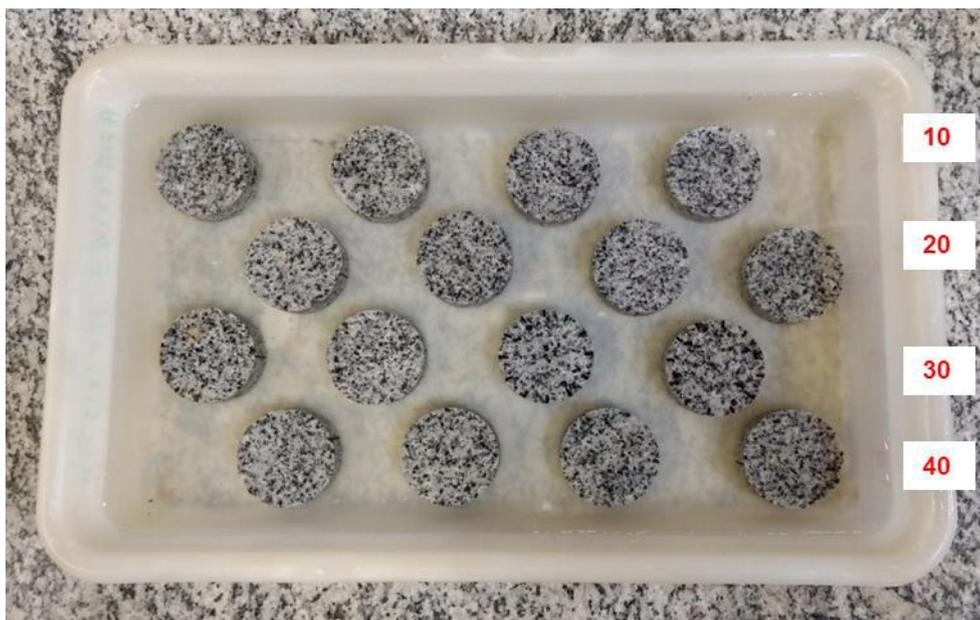
**Figura 9 - Amostras submersas em solução com NaCl e posicionadas conforme o número de ciclos pré-definidos.**
