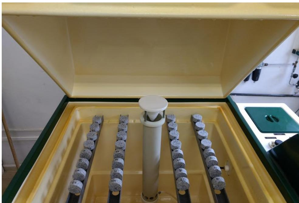
**Figura 10 - Câmara de névoa salina utilizada para o ensaio, com corpos de prova posicionados.**
