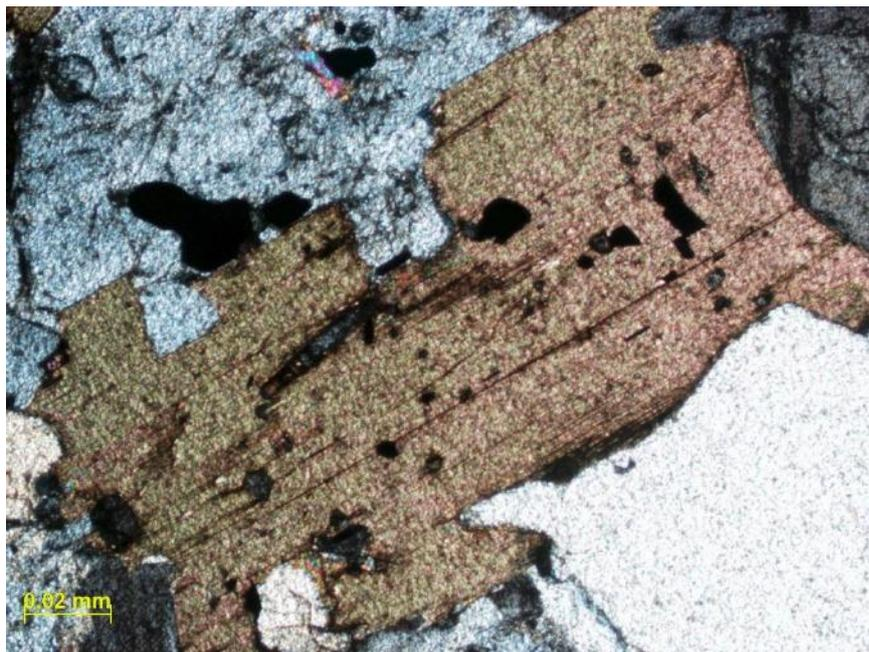
**Figura 15 - Lâmina delgada perpendicular mostrando biotita com inclusões, bordas de reação e alterações, a nicóis cruzados.**
