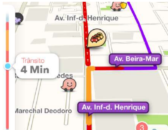
Figura 3.1: Captura de tela do programa Waze: Linhas vermelhas e laranjas para exibição de níveis de congestionamento e linha lilás para exibição de melhor trajeto.
