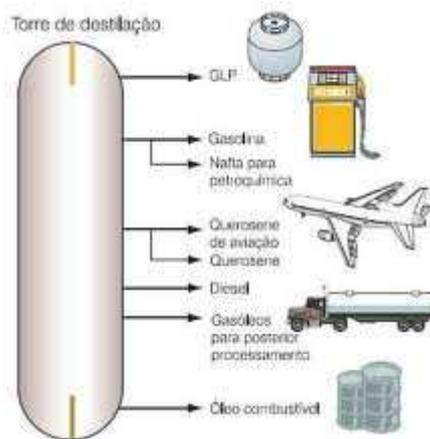
**Figura 14:** Esquema do fracionamento do petróleo em uma torre, com os diferentes produtos obtidos (foto de Geraldo Falcão - gentileza Petrobras)
