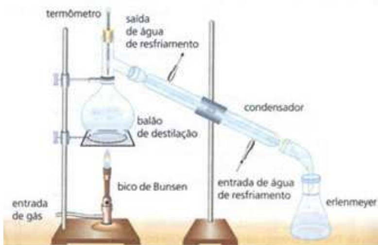
**Figura 11:** Esquema de uma destilação simples
