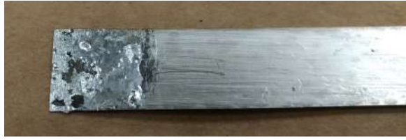
(a) Camada de Ag dissolvida na extremidade da fita por solda de In-Sn
