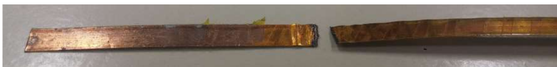
Figura 5.13: Fita HCNK04150 rompida por super aquecimento em ensaios de 200 ms x 500 ms.
