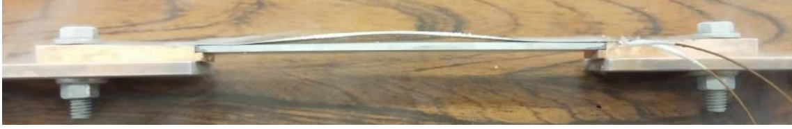
Figura 4.13: Fitas SF12050 envergadas pela contração térmica diferencial inerente no primeiro design do current lead ao banhar conjunto em LN_2 .
