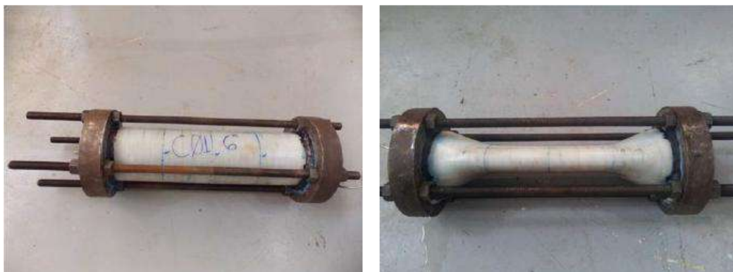
Figura 4.25 – Amostra de 6” composta apenas pela carcaça e camada plástica interna antes e após teste de colapso (SILVA,2014)
