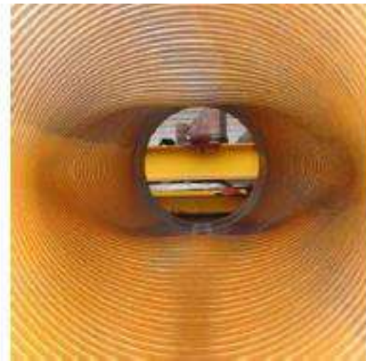
Figura 2.9 – Colapso com anular seco, falha por ovalização: (a) (SOUSA,2005) e (b) (PAUMIER et al, 2009)
