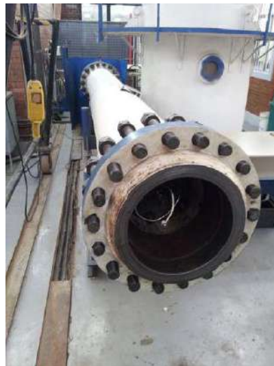
Figura 4.24 - Câmara hiperbárica utilizada por SILVA(2014).
