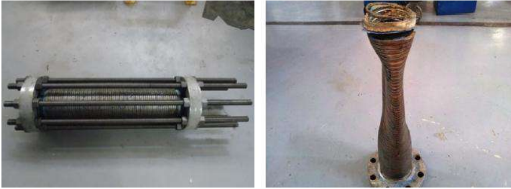
Figura 4.26 – Amostra de 6” composta pela carcaça, camada plástica interna e armadura de pressão antes e após teste de colapso. (SILVA,2014)
