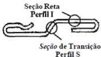
Figura 4.2 - Seções da carcaça intertrava de onde SOUZA (2002) retirou os corpos de provas.
