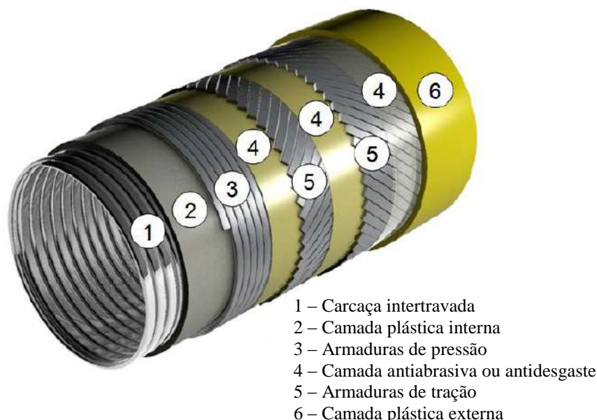
Figura 2.2 - Duto flexíveis de camadas não aderentes ( unbonded ) (Adaptado de FERGESTAD E LØTVEIT, 2014 )
