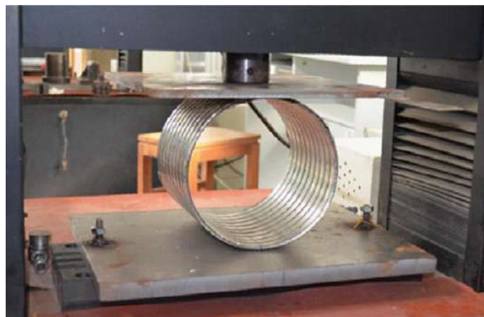
Figura 3.3 - Compressão radial em uma carcaça através de sapatas com \alpha=180^\circ (TANG et al 2015)
