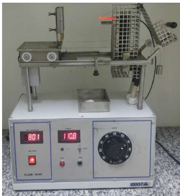
Figura 3-15: Equipamento fio incandescente empregado no ensaio.
