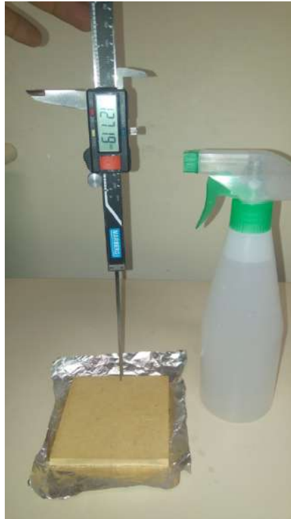
Figura 3-3: Tratamento superficial com retardante de chamas
