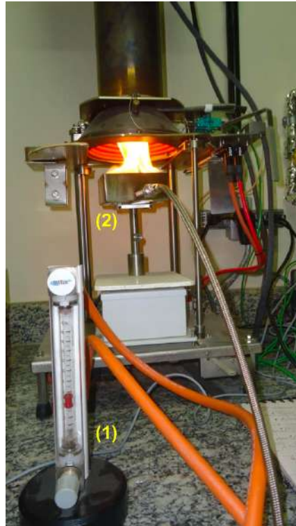
Figura 3-9: Procedimento de calibração da termopilha.
