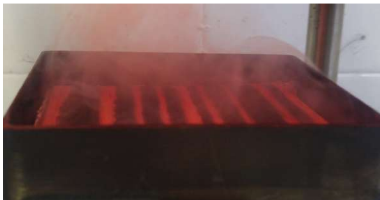
Figura 4-3: Taxas de carbonização diferentes no Pinus elliottii .
