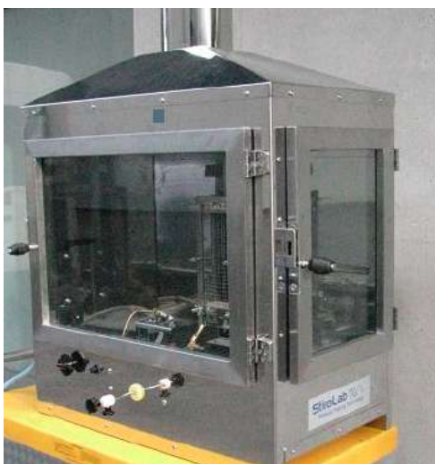
Figura 2-7: Fotografia do aparato do Ignitability Test (Ensaio de ignitabilidade). 6
