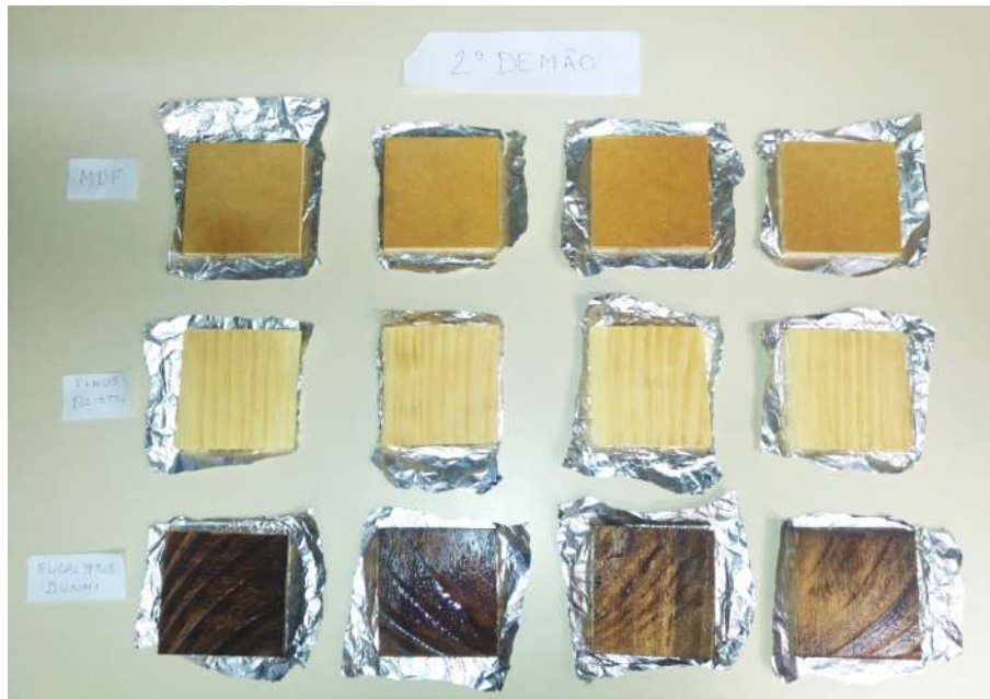
Figura 3-4: Segunda demão do tratamento com o retardante de chamas.
