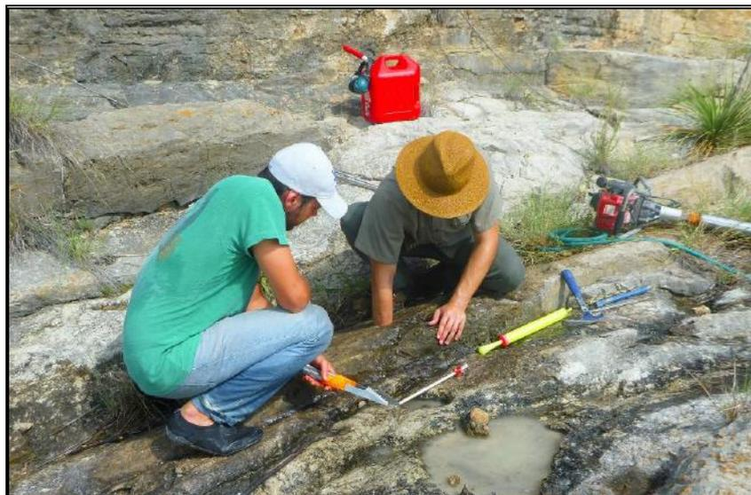
**Figura 11** – Retirada de um dos testemunhos. No topo da foto é possível observar o tanque de gasolina utilizado para alimentar a bomba de água e a sonda rotativa. Nas mãos do autor (de camisa verde) observam-se os pegadores desmembrados de churrasco. Soltos ao chão, o sugador de água (amarelo), bem como martelos, uma chave de fenda, um cinzel e, apoiada no canto direito, a sonda rotativa. Foto tirada por André Droxler no dia 19.07.2015
