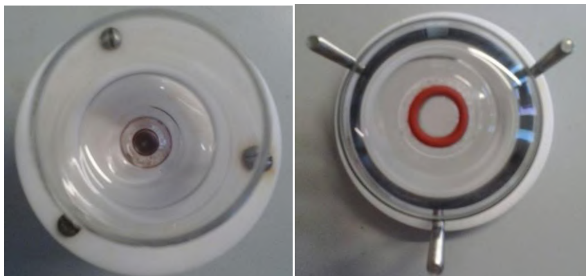
Figura 5: a) Visão superior b) Visão inferior da cuba eletroquímica utilizada para os ensaios eletroquímicos
