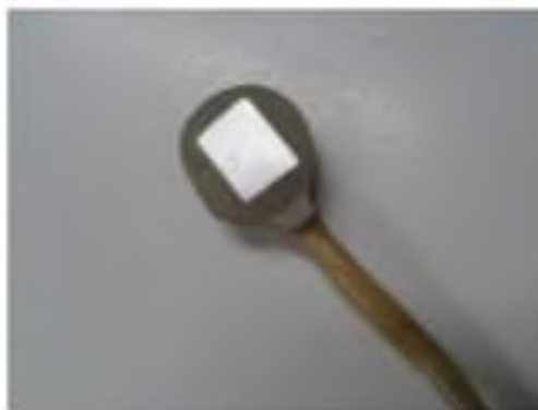
Figura 4.5 – Eletrodo de trabalho de aço-carbono 1020
