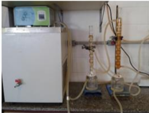
Figura 4.2- Banhos com sistema de aquecimento, utilizado nos ensaios gravimétricos com variação de temperatura
