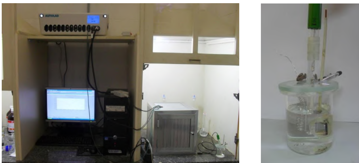
Figura 4.6: Potenciostato /galvanostato e célula eletrolítica utilizados nos ensaios eletroquímicos
