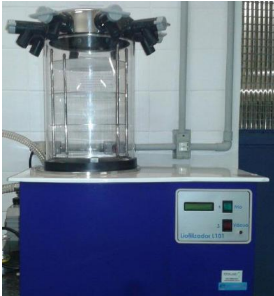
Figura 4.1 – Liofilizador utilizado para a obtenção do extrato de casca de cebola.
