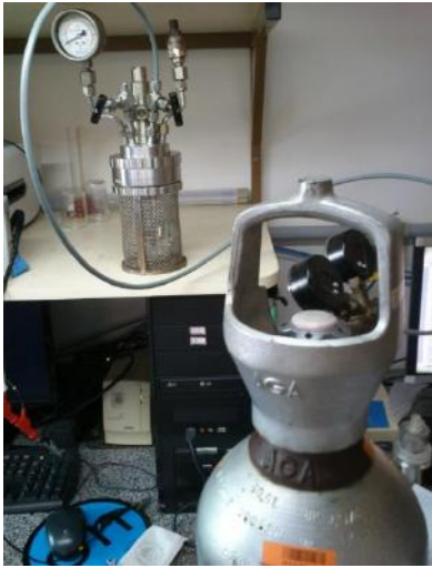
Figura 4.3: Borbulhamento do sistema com CO 2 a 5 bar
