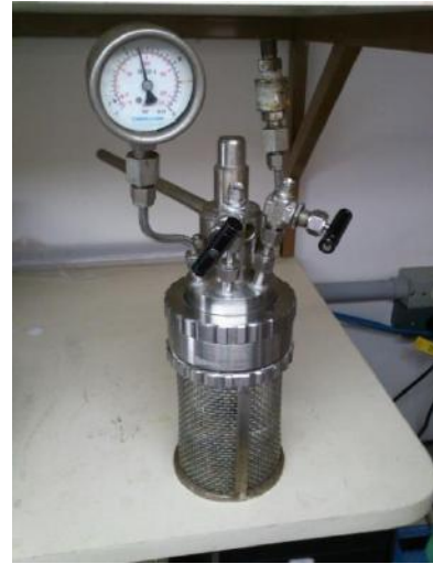
Figura 4.4: Sistema autoclave pressurizado para troca de atmosfera
