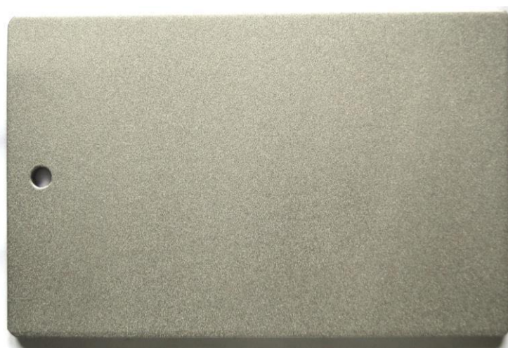
Figura 3. Aspecto de uma chapa de aço-carbono após o jateamento abrasivo seco (grau de limpeza Sa3).
