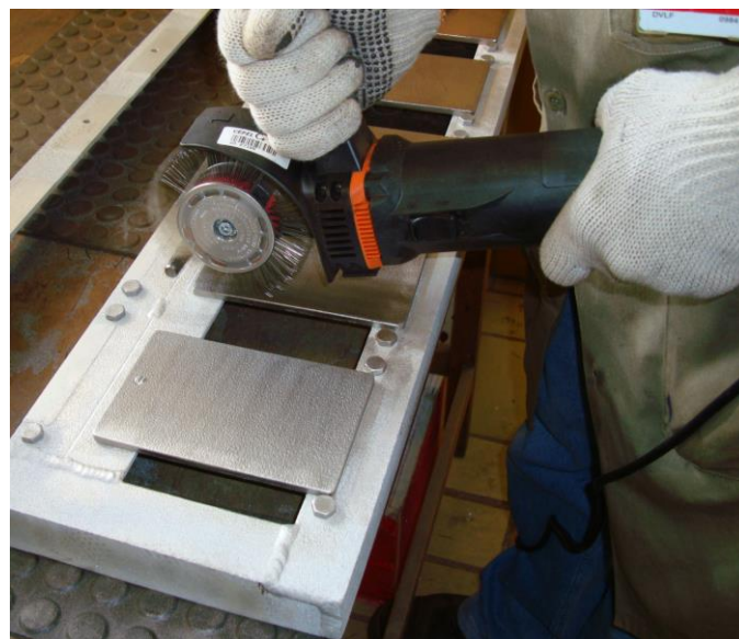
Figura 5. Aspecto visual da chapa tratada com o equipamento Bristle Blaster
