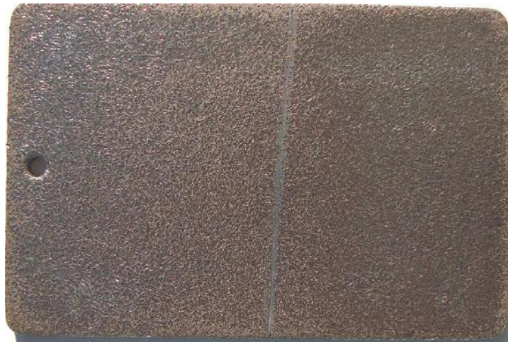
Figura 4. Aspecto de uma chapa de aço-carbono após tratamento com lixadeira elétrica e escova de aço (grau de limpeza St3).
