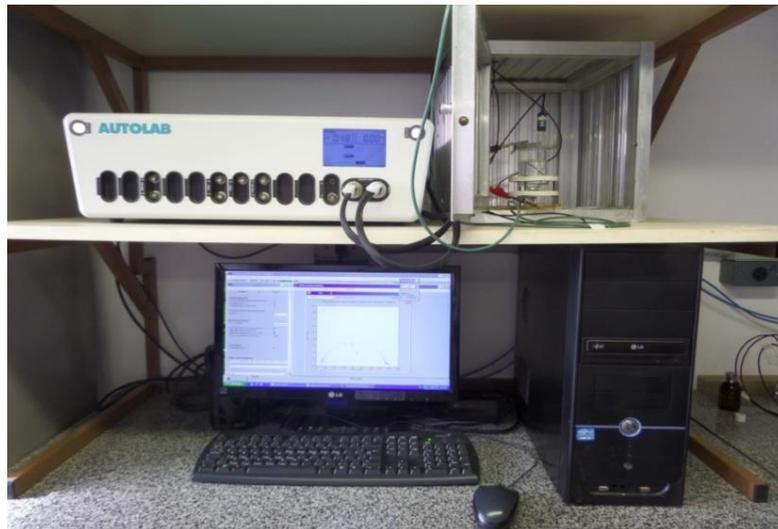
**Figura 4.4 - Potenciostato acoplado a um microcomputador usado nas análises de impedância eletroquímica e polarização.**
