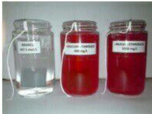
Figura 4.2 - Sistema para ensaio gravimétrico variando a concentração e o tempo à temperatura ambiente, em meio ácido.
