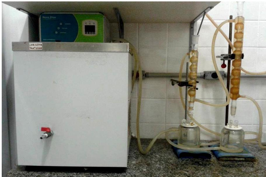
Figura 4.3 - Sistema de aquecimento, utilizado nos ensaios gravimétricos com variação de temperatura
