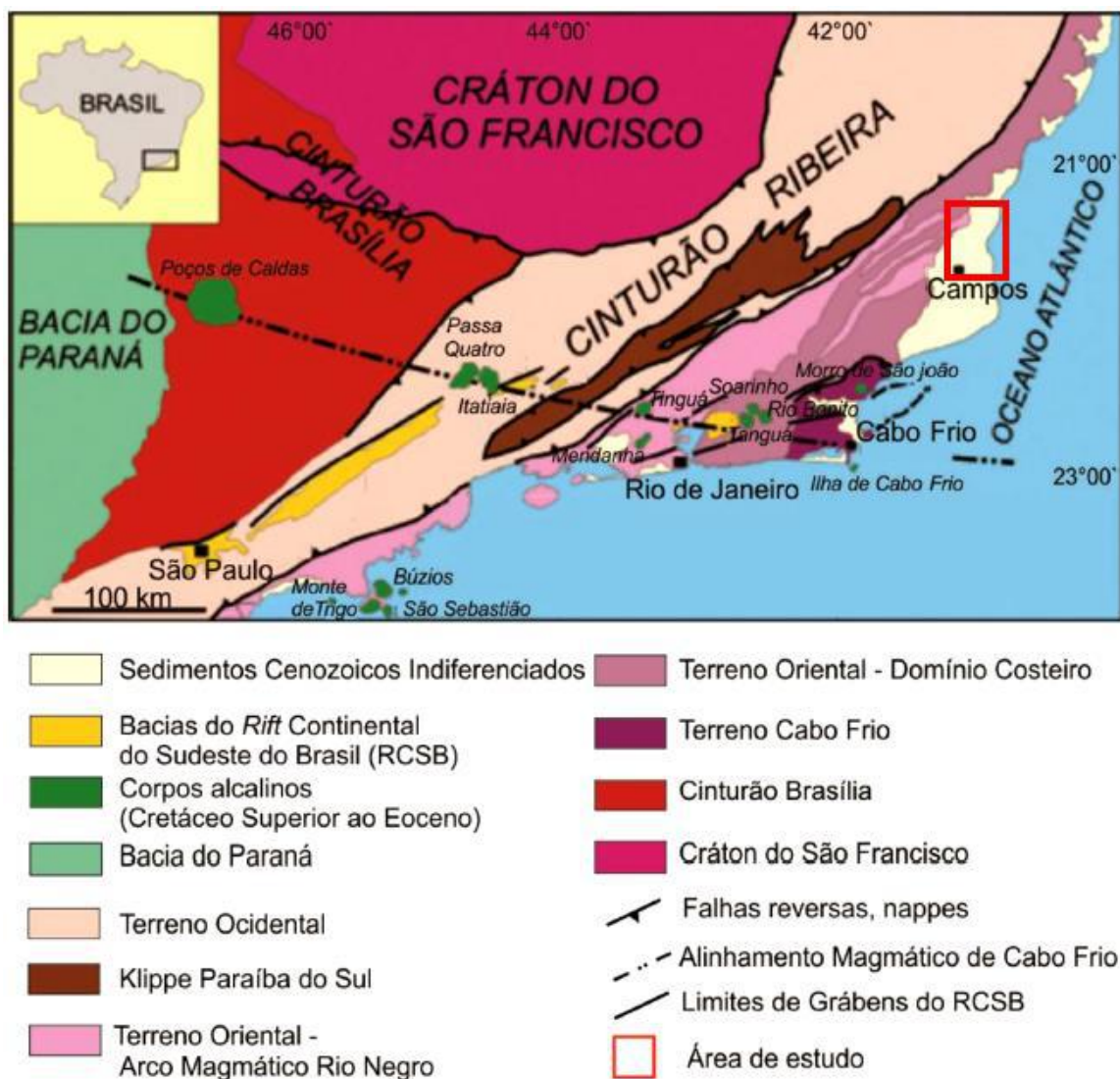
Figura 3.6 – Mapa tectônico do Sudeste brasileiro, de acordo com Riccomini et al. (2004), com destaque para a localização da área de estudo no domínio dos Sedimentos Cenozoicos Indiferenciados, em contato com o Terreno Oriental-Domínio Costeiro.
