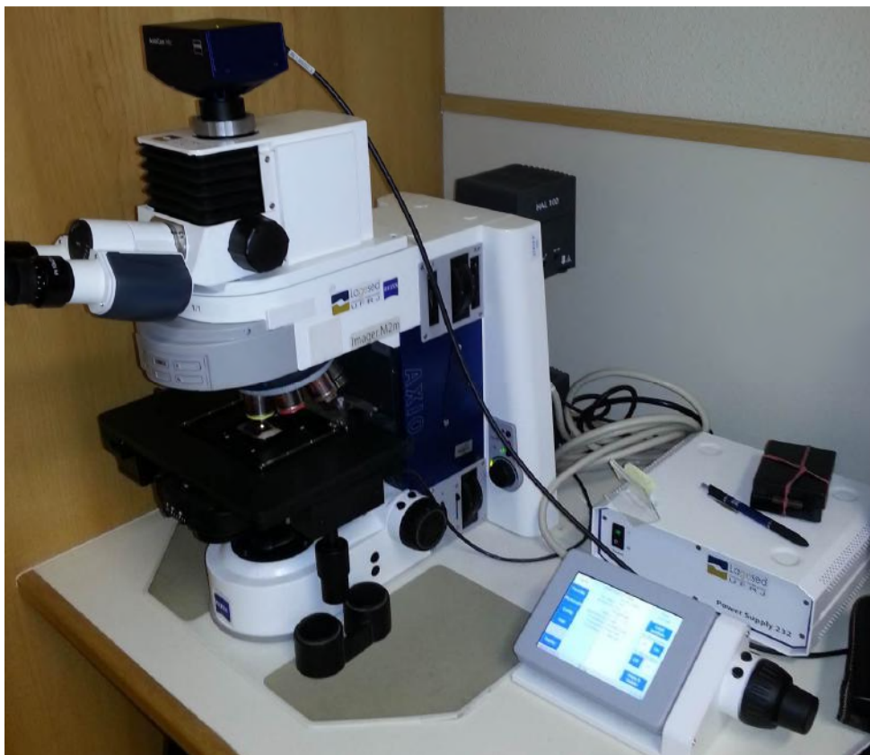
Figura 3- Zeiss Axio Imager M2M, utilizado para descrição e digitalização das lâminas delgadas. Este equipamento foi importante por possibilitar digitalização em alta resolução das lâminas, o que possibilitou binarização da lâmina e descrição detalhada.
