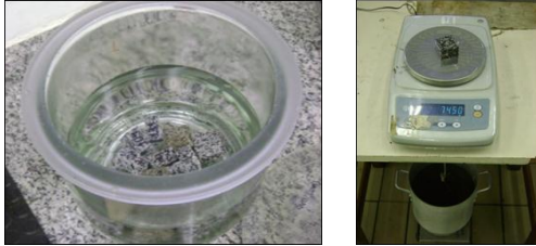
Figura 6- Imersão das amostras em água destilada por 48 horas (à esquerda) para a medida das massas saturada e submersa (balança à direita)
