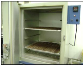
Figura 7- Estufa utilizada para obtenção da massa seca
