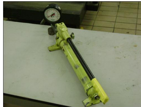
Figura 9- Ensaio de point load
