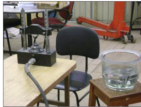
Figura 8- Ensaio de point load
