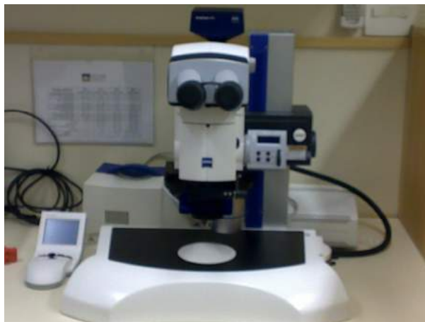
Figura 6 - Estereomicroscópio da marca Carl Zeiss, modelo Discovery V12, do Laboratório de Geologia Sedimentar (LAGESED) do Departamento de Geologia/ UFRJ.
