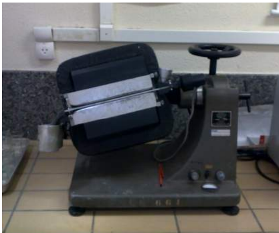
Figura 3 - Separador eletromagnético Frantz, do Laboratório de Sedimentologia Analítica do Departamento de Geologia/UFRJ.
