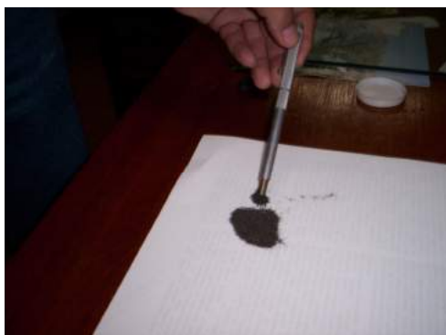
Figura 2 - Uso de ímã de mão para a retirada de minerais ferromagnéticos (ex. magnetita).
