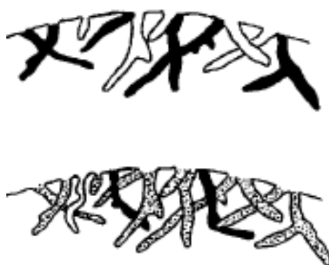
Figura 14 - Esquema mostrando a micritização destrutiva: Cianobactérias endolíticas, algas ou fungo produzem microtubos (em preto) na superfície dos bioclastos. Microtubos vagos (em branco) originados após a morte dos endolitos são preenchidos por cimento carbonático microcristalino. Múltiplas perfurações e preenchimento resultam na formação de envelope micrítico. (Bathurst, 1966).
