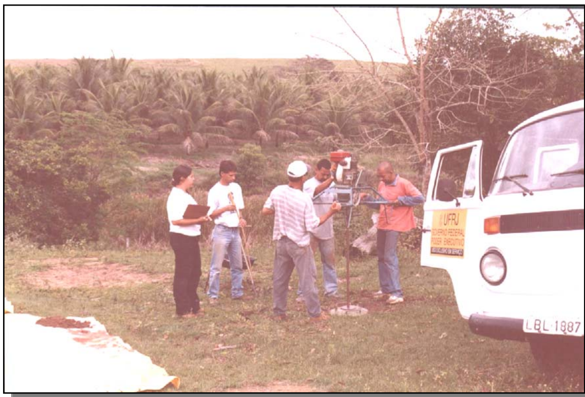
Figura 10: Funcionamento do trado mecânico.
