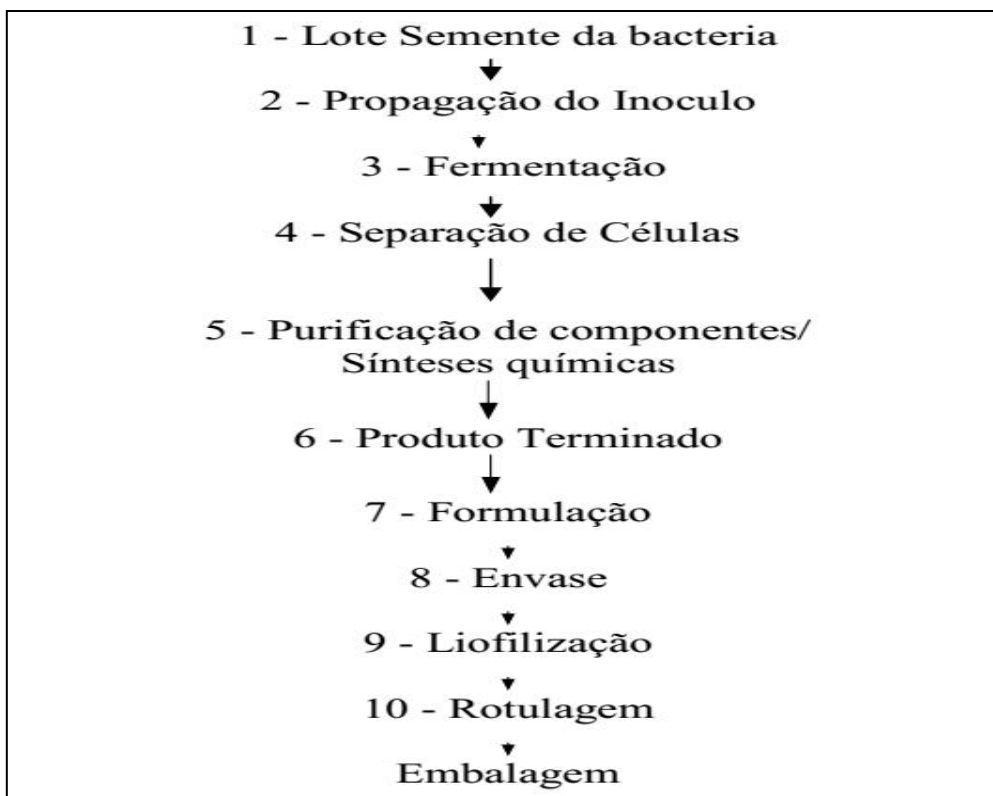
Figura 16: Fluxograma de produção clássica de vacinas bacterianas
