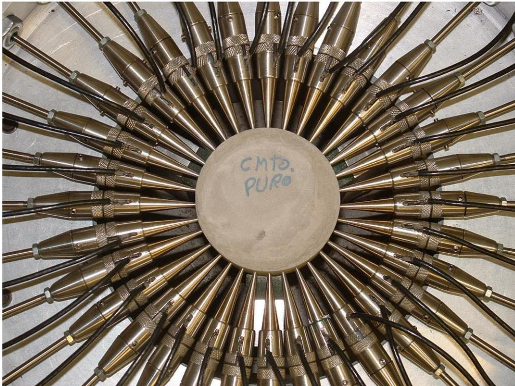
Figura 7 – Detalhe do arranjo dos pistões em volta do “testemunho” artificial fabricado de cimento puro.
