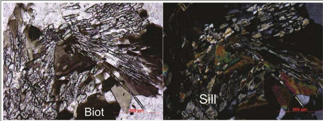
Figura 32 - Fotomicrografia do ponto OSP-03 (pedreira), mostrando sillimanita (Sill) e biotita (Biot).
