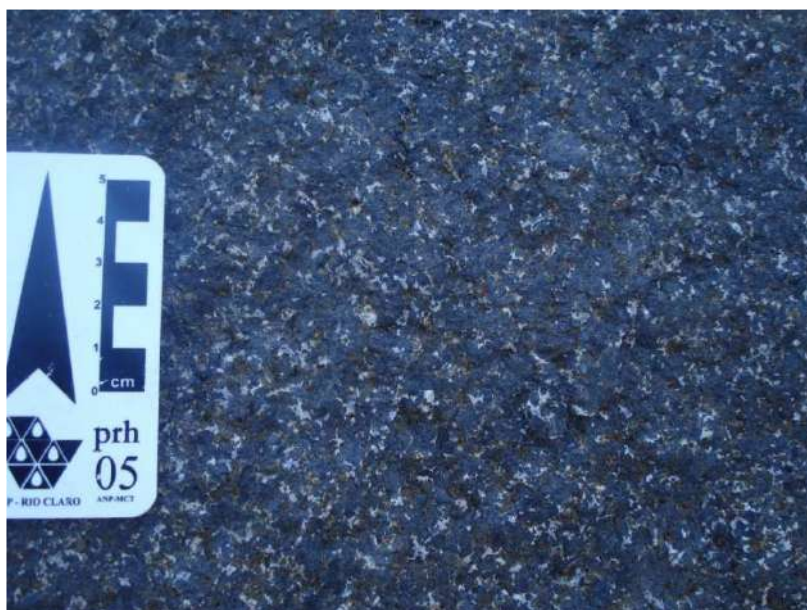
Figura 35 - Rocha ultramáfica vista em afloramento com textura cumulativa (Ponto TMM 10).
