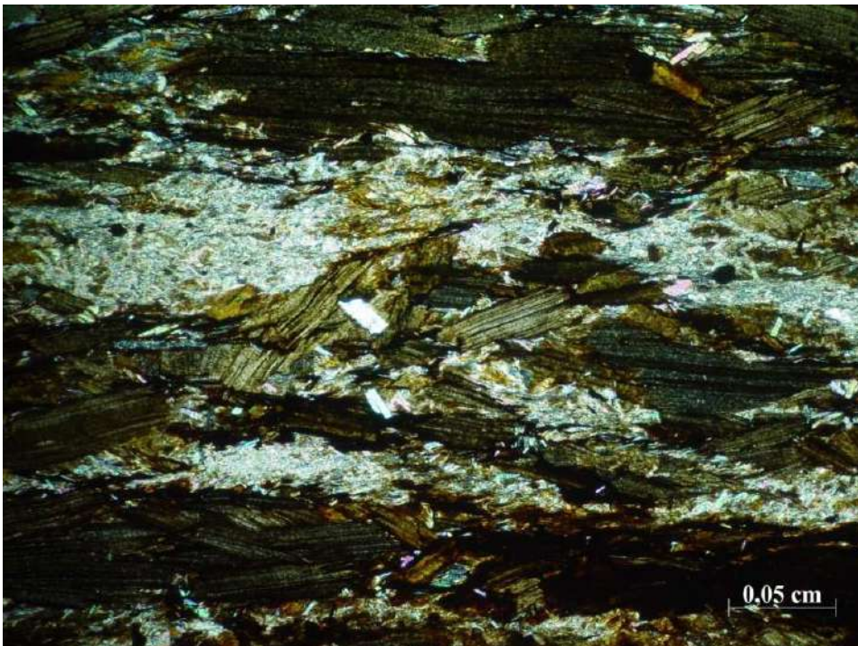
Figura 16 - Muscovitas ocorrendo de duas formas: definindo a foliação e obliqua a foliação da rocha (Ponto TMM 87).
