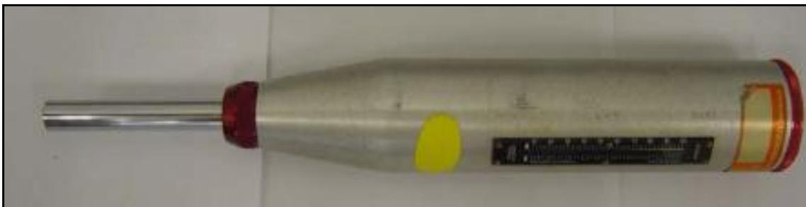
**Figura 8: Esclerômetro do tipo L.**
