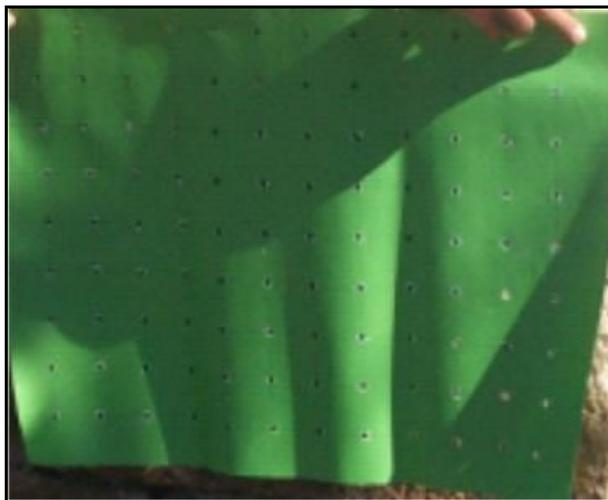
**Figura 10: Malha regular para ensaio de esclerometria nos blocos.**
