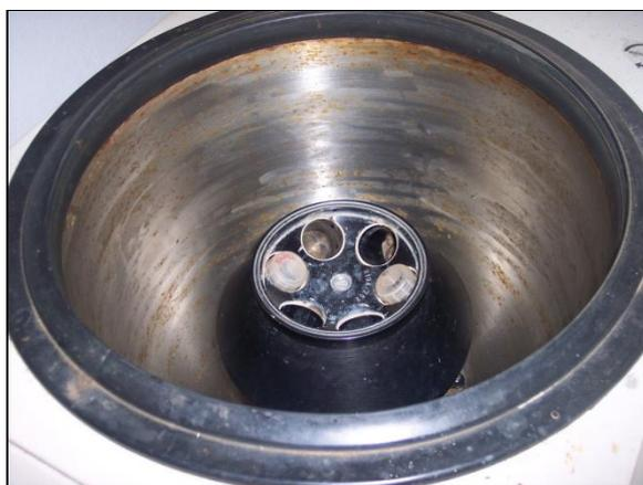
**Figura 15: Ensaio para separar sobrenadante da amostra.**
