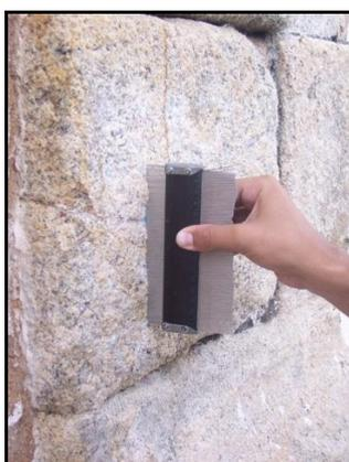
**Figura 12: Perfilógrafo usado para gerar perfis de rugosidade**
