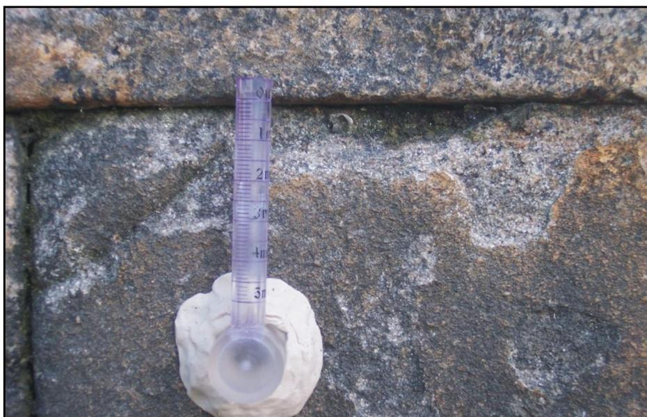
**Figura 11: Tubo graduado para ensaio de absorção.**
